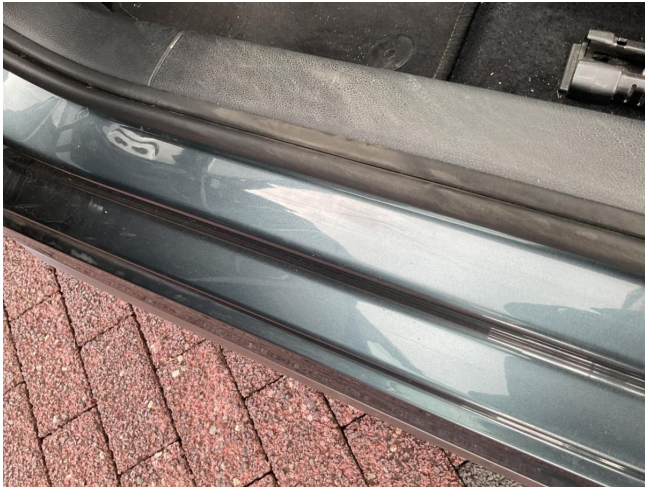
Vorne Tür Kante innen - nass schleifen polieren
