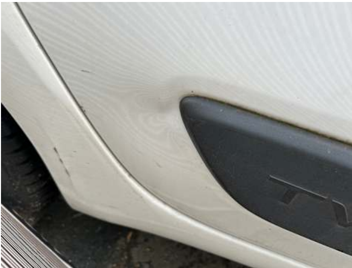
Türe hinten rechts (Verformung, Kratzer)
