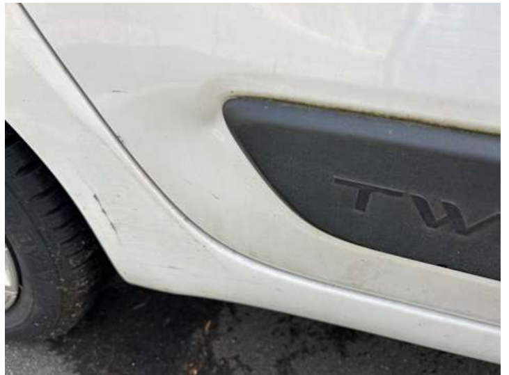
Türe hinten rechts (Verformung, Kratzer)
