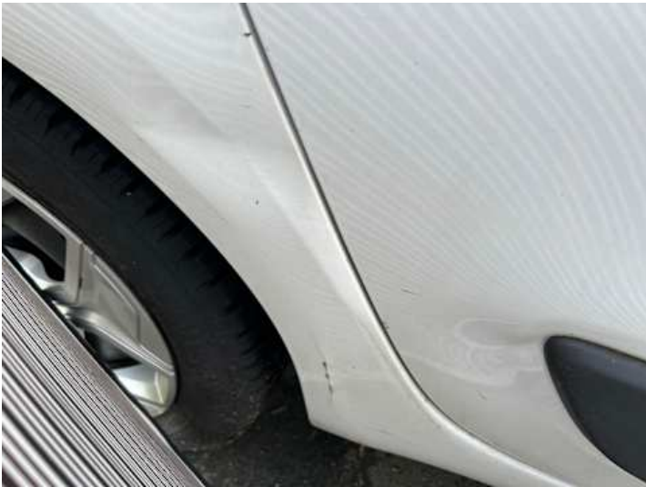
Seitenteil hinten rechts (Kratzer, Verformung)
