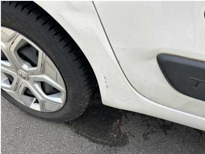
Seitenteil hinten rechts (Kratzer, Verformung)
