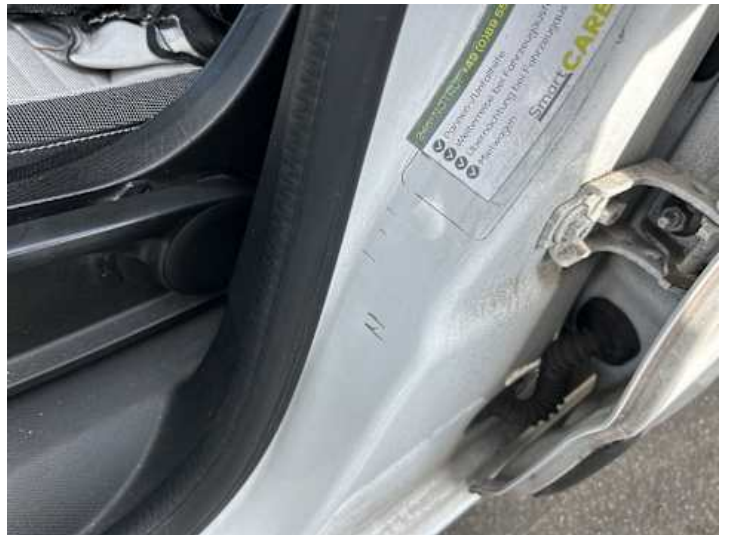
Schweller links (Kratzer, Delle)
