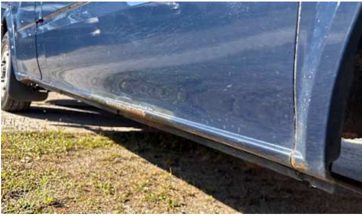
Schweller links (Rost)
