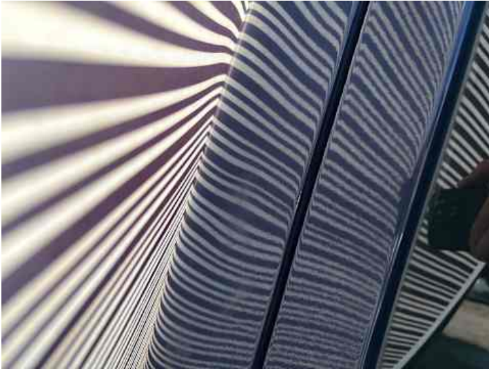
Seitenteil hinten links (Delle)
