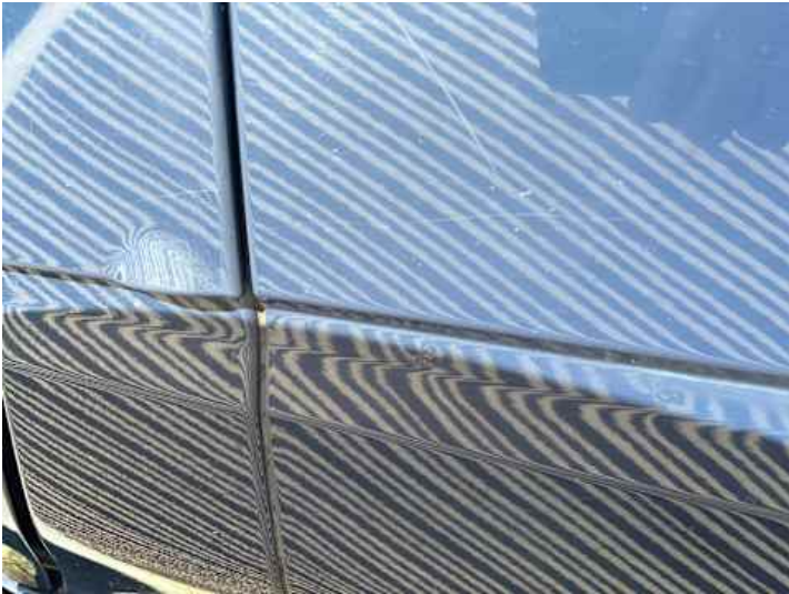
Seitenteil hinten links (Delle)
