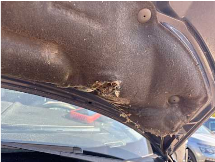
Motorhaube (Anderer Schaden): Dämmung beschädigt
