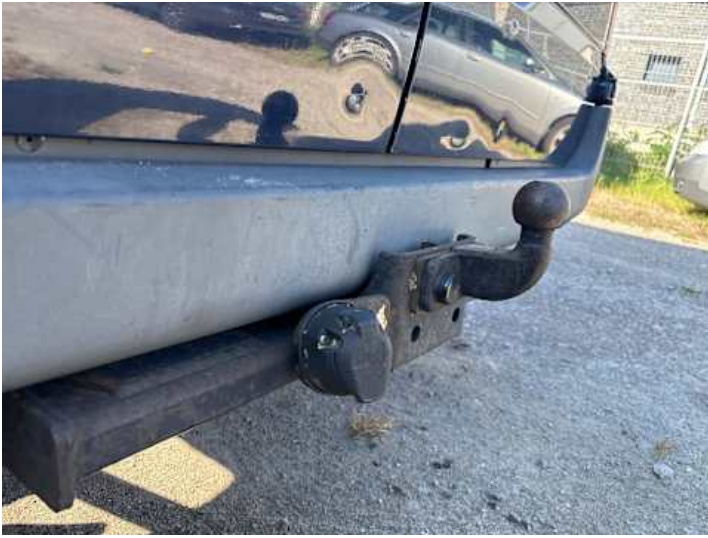
Stoßstange hinten (Anderer Schaden): Steckdose verbogen
