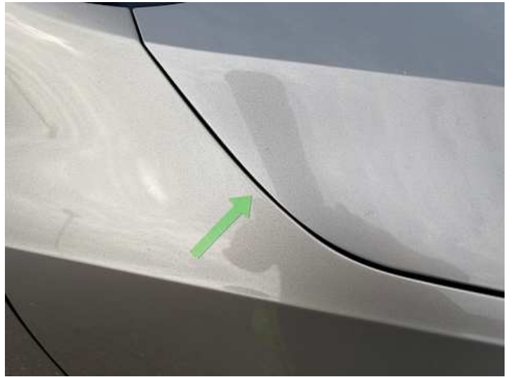
Motorhaube (Spaltmaße ungenau)
