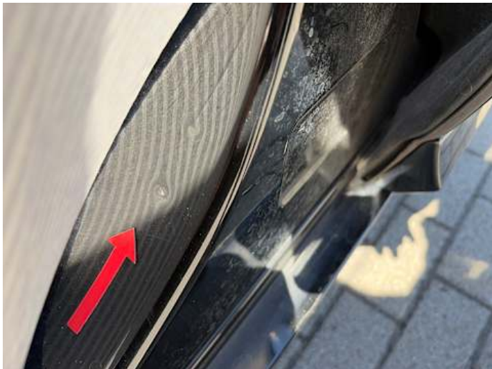
Fahrtür (Kratzer, Delle)
