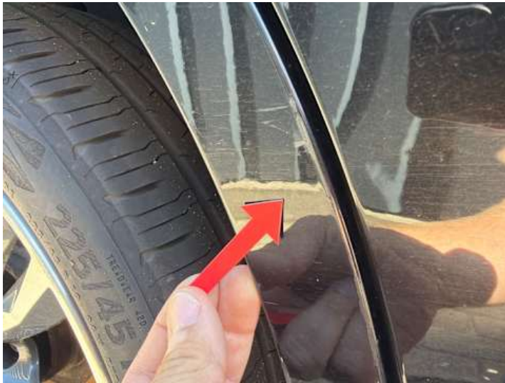
Seitenteil hinten rechts (Kratzer)
