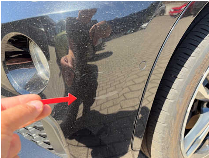
Stoßstange vorne (Kratzer)
