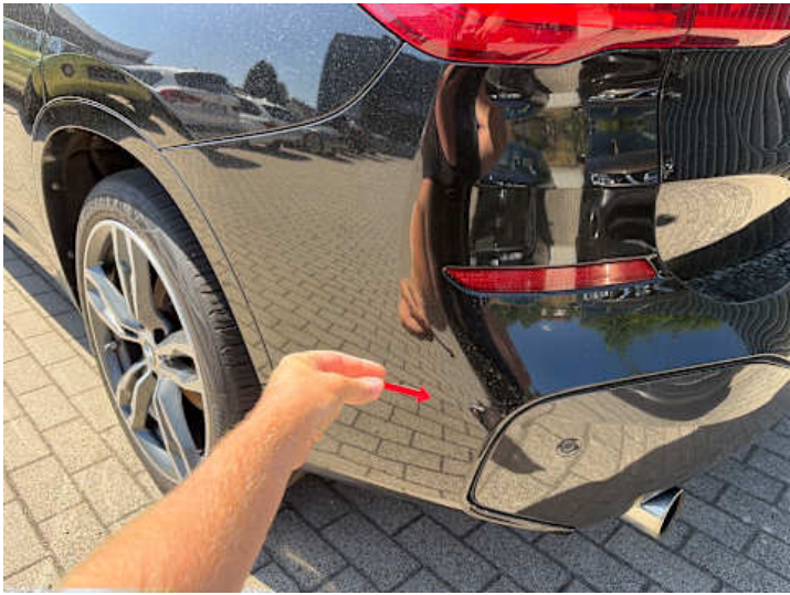
Stoßstange hinten (Kratzer)
