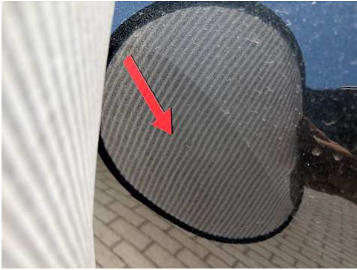
Türe hinten links (Kratzer, Delle)
