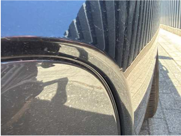
Stoßstange hinten (Kratzer)
