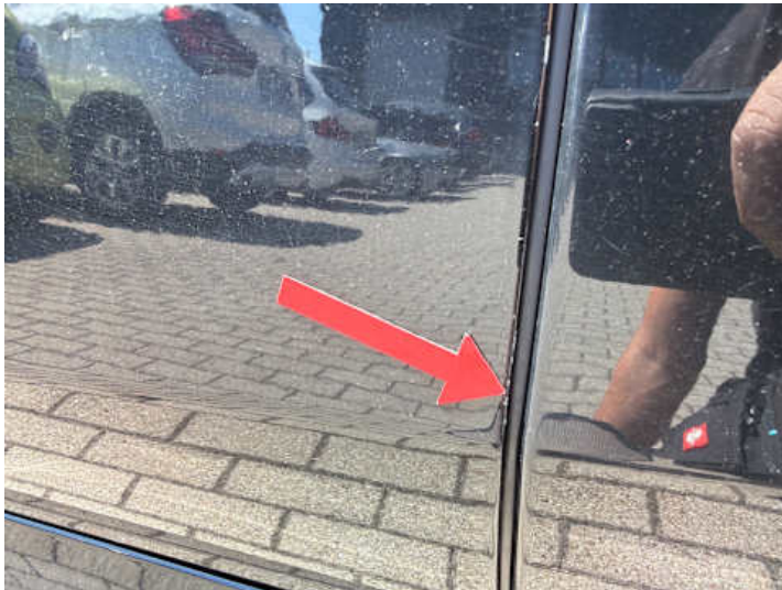
Fahrtür (Kratzer, Delle)
