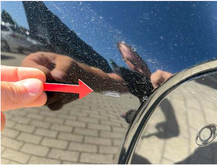
Stoßstange hinten (Kratzer)
