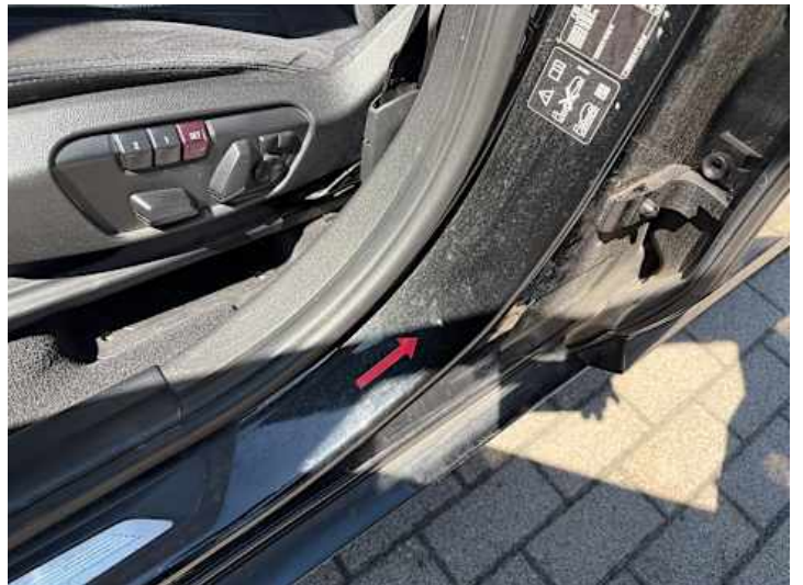
Fahrtür (Kratzer, Delle)
