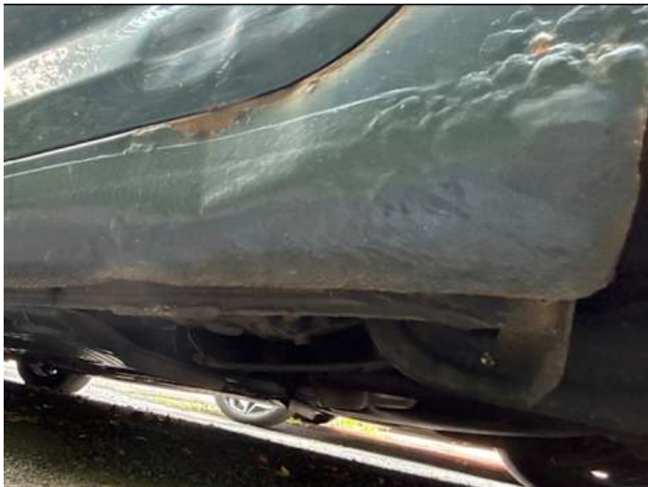
Schweller links (Rost, Verformung)
