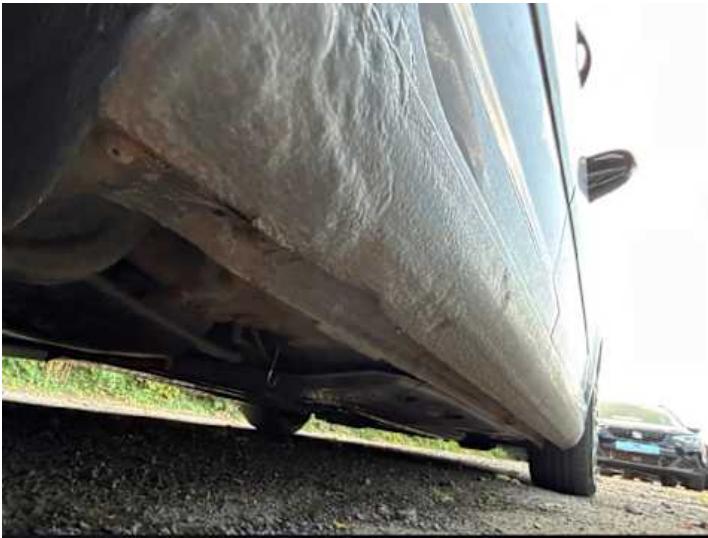
Schweller rechts (Rost, Verformung)
