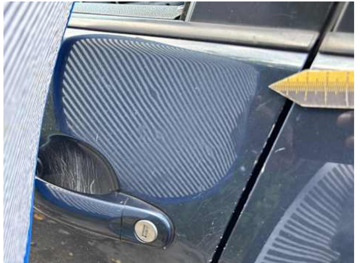
Fahrtür (Delle, Kratzer)
