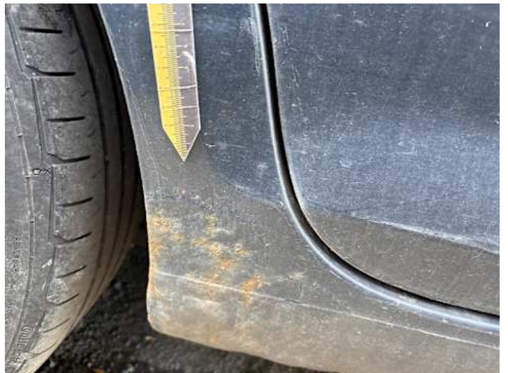
Seitenteil hinten rechts (Verformung, Kratzer, Rost)
