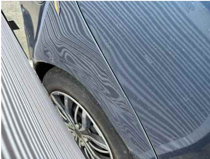
Seitenteil hinten rechts (Verformung, Kratzer, Rost)
