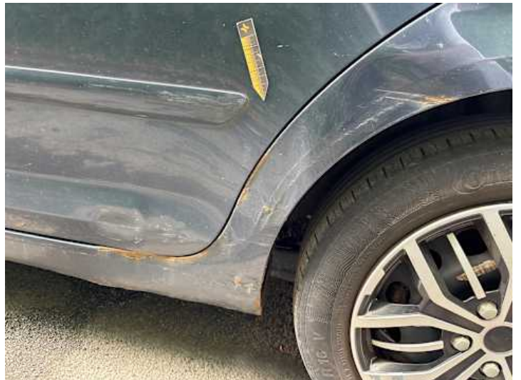
Schweller links (Rost, Verformung)
