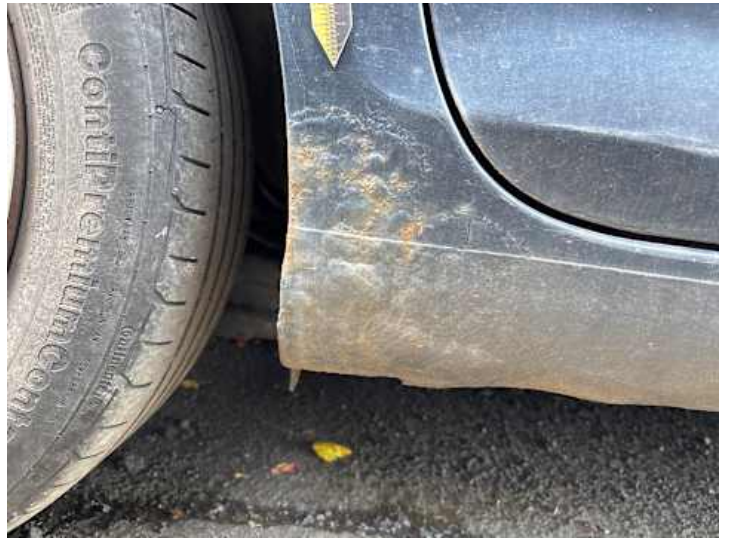
Schweller rechts (Rost, Verformung)
