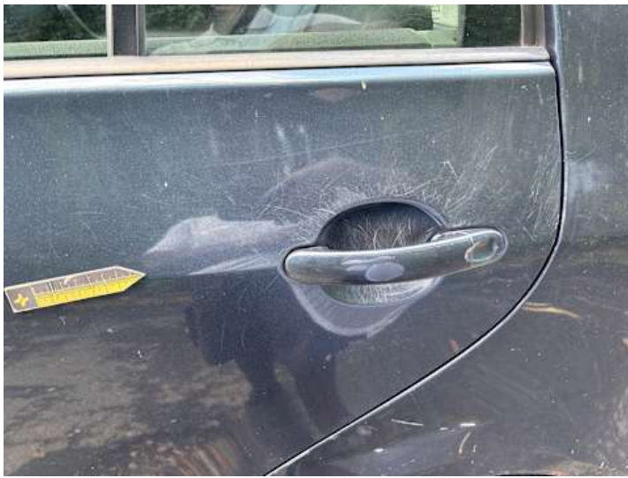
Türe hinten links (Kratzer)
