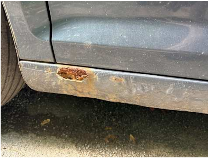
Schweller links (Rost, Verformung)
