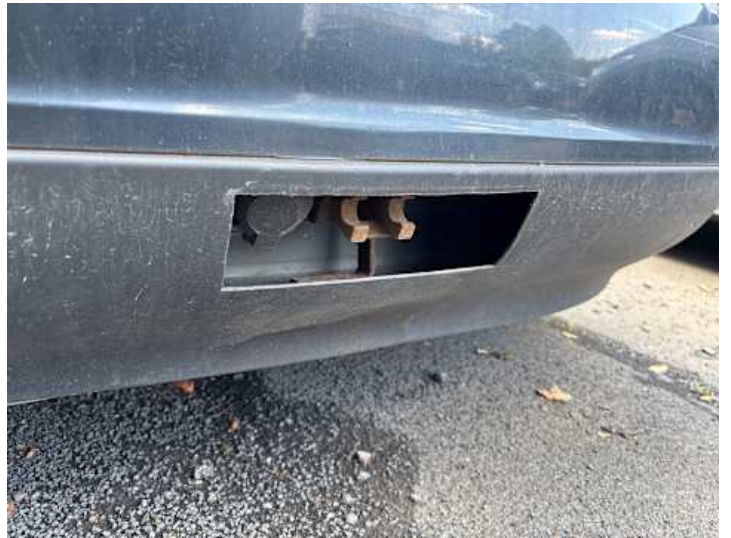
Stoßstange hinten (Anderer Schaden): Abdeckung fehlt
