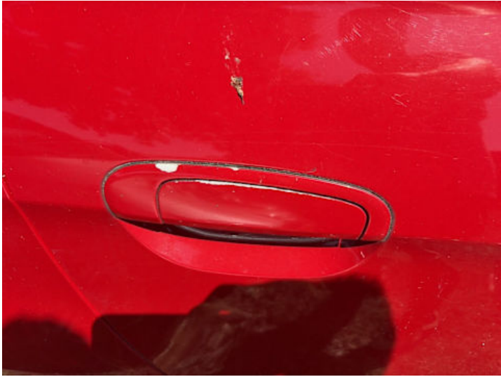
Türe hinten rechts (Lackschaden)
