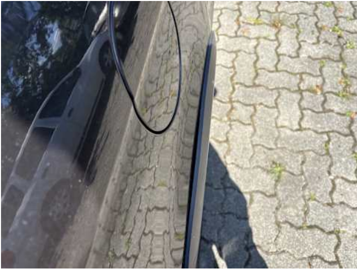
Seitenteil hinten rechts (Spaltmaße ungenau)
