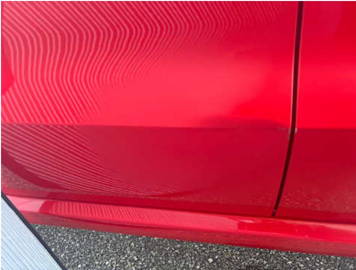
Türe hinten rechts (Verformung, Lackschaden, Unsachgemäß instand gesetzt)
