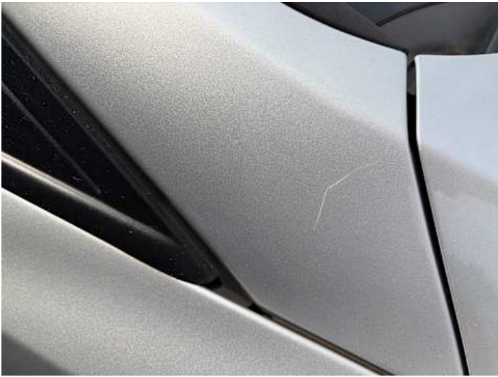
Dach (Lackschaden, Kratzer)
