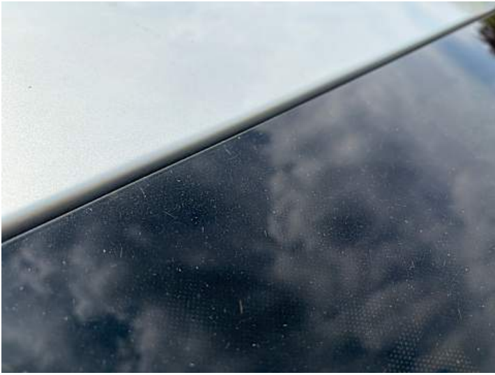
Dach (Lackschaden, Steinschlag)
