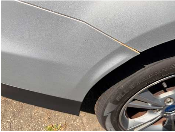
Stoßstange hinten (Lackschaden, Kratzer)
