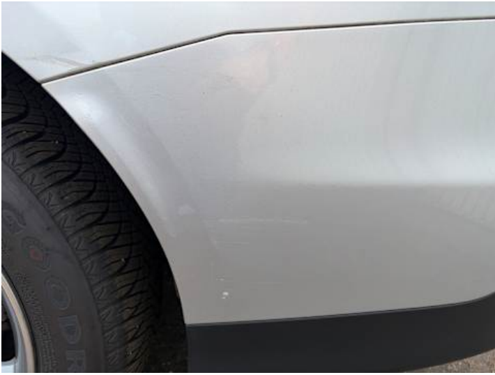
Stoßstange hinten (Lackschaden, Kratzer)
