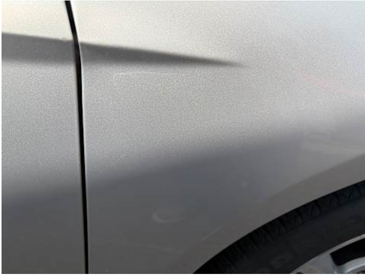
Kotflügel vorne rechts (Lackschaden, Kratzer)
