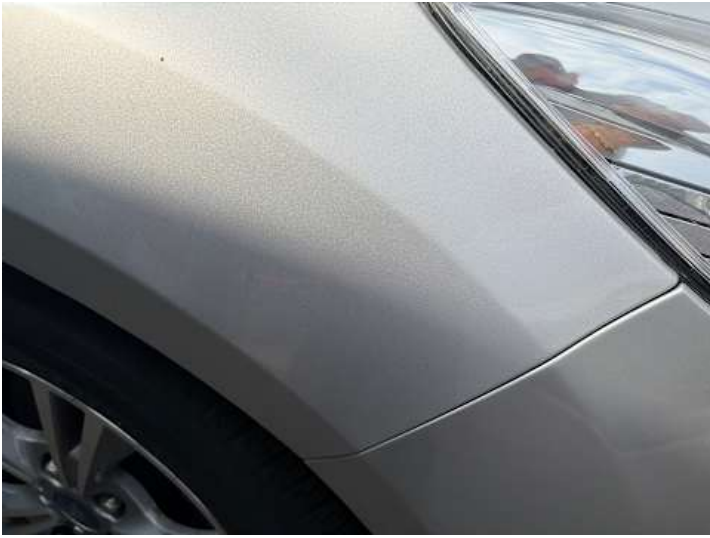
Kotflügel vorne rechts (Lackschaden, Kratzer)
