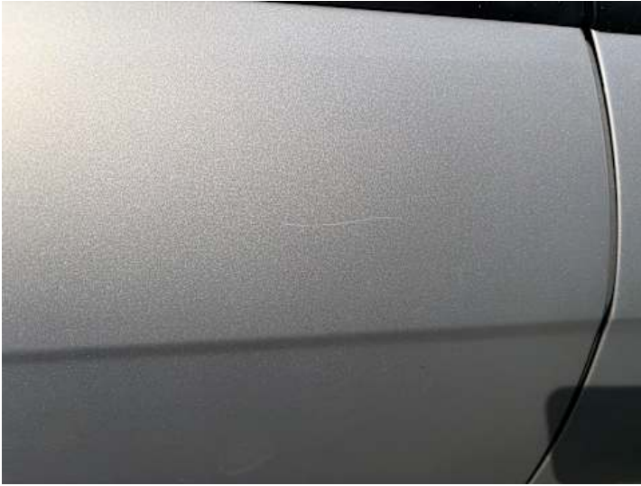
Türe hinten rechts (Lackschaden, Kratzer)
