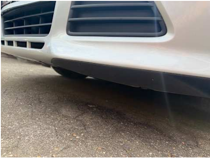
Stoßstange vorne (Lackschaden, Kratzer)
