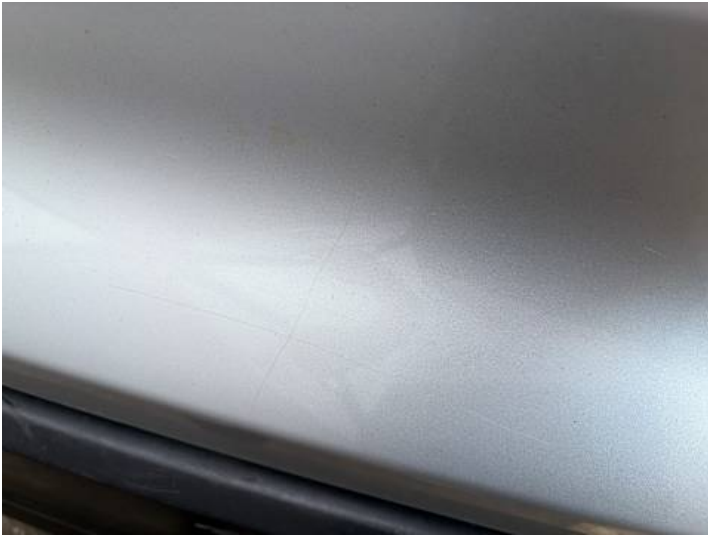
Heckklappe (Lackschaden, Kratzer)
