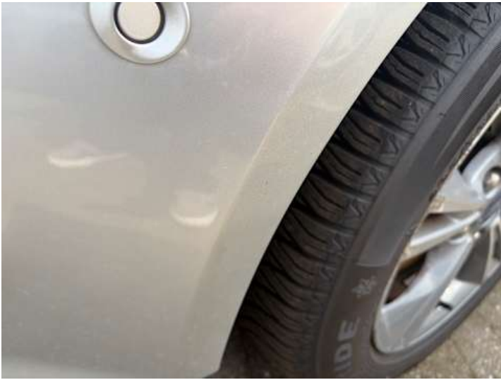
Stoßstange vorne (Lackschaden, Kratzer)
