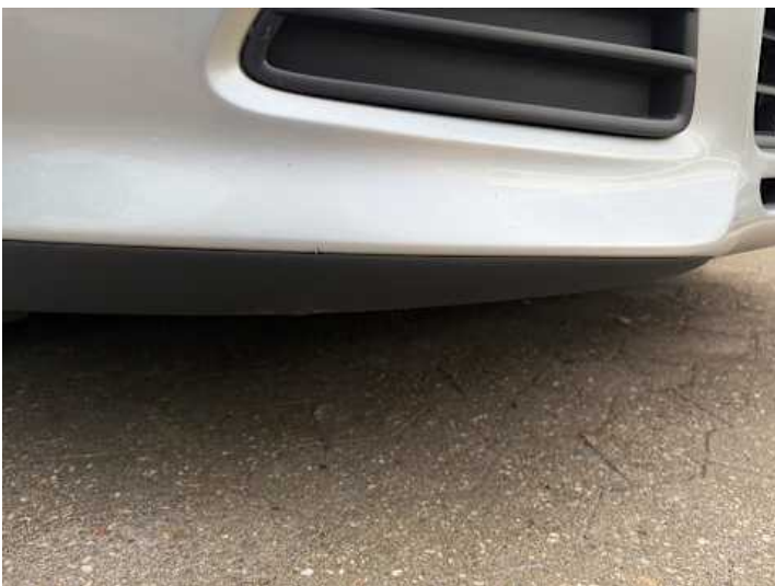
Stoßstange vorne (Lackschaden, Kratzer)
