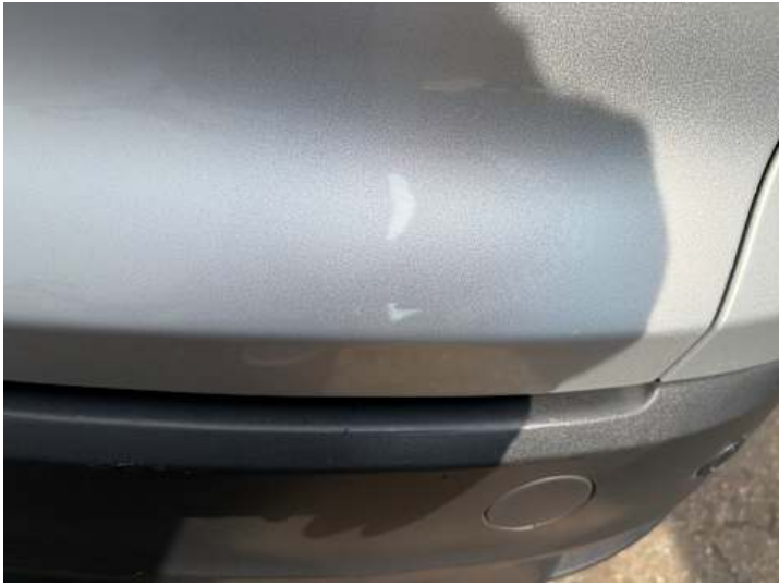
Heckklappe (Lackschaden, Kratzer)
