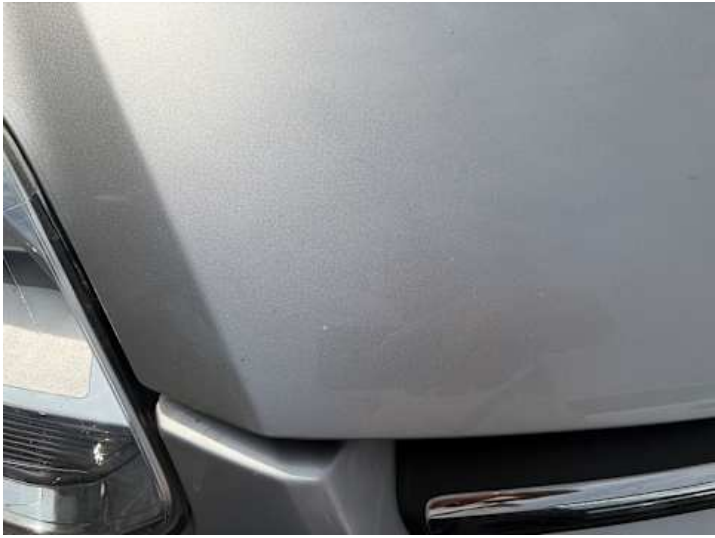
Motorhaube (Lackschaden, Kratzer)
