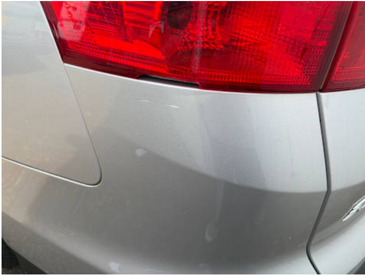
Stoßstange hinten (Lackschaden, Kratzer)
