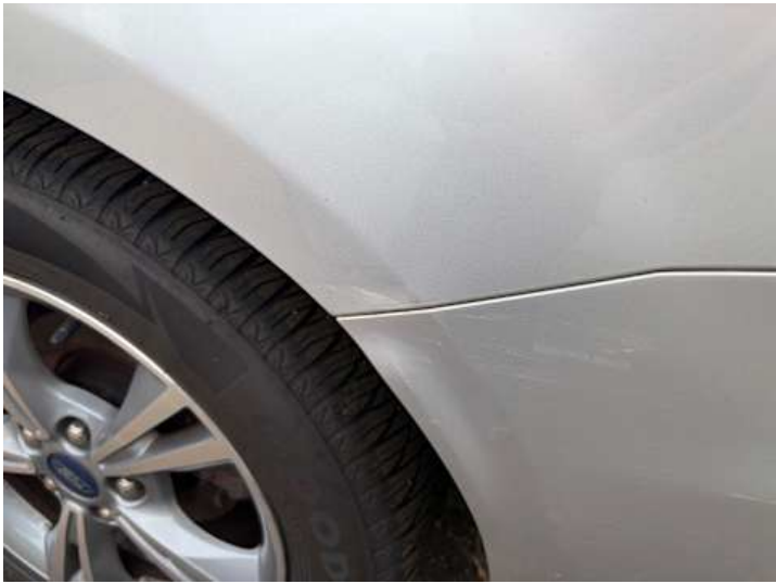
Seitenteil hinten links (Lackschaden, Kratzer)
