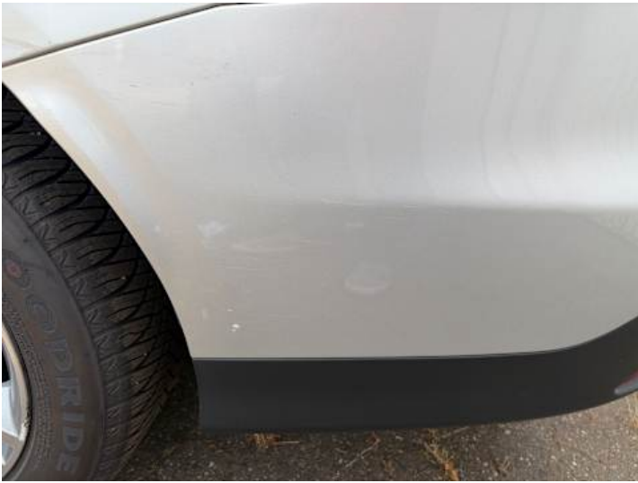
Stoßstange hinten (Lackschaden, Kratzer)
