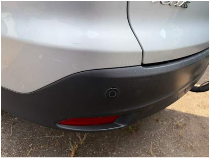
Stoßstange hinten (Lackschaden, Kratzer)
