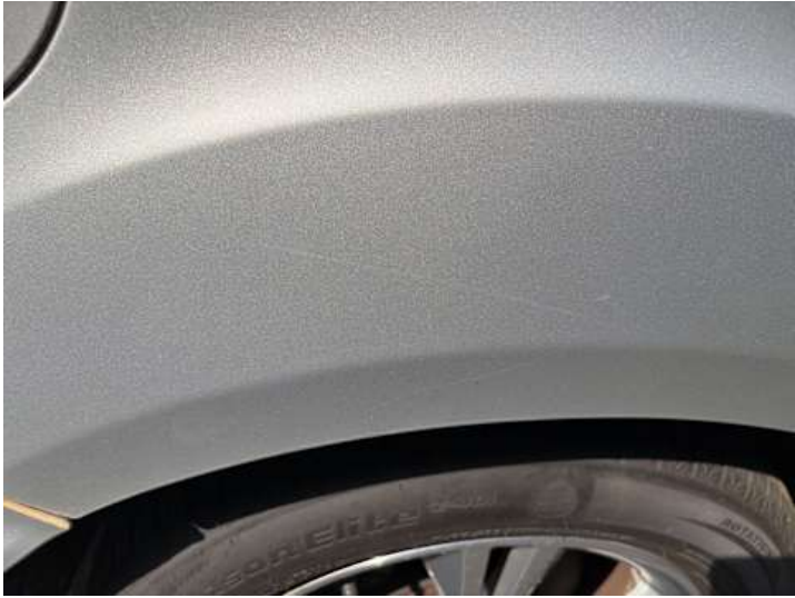
Seitenteil hinten rechts (Lackschaden, Kratzer)
