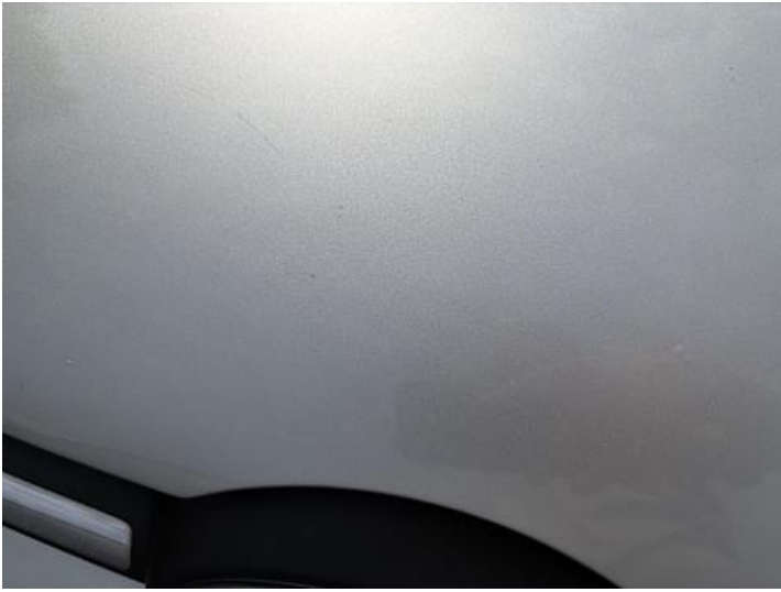
Motorhaube (Lackschaden, Kratzer)
