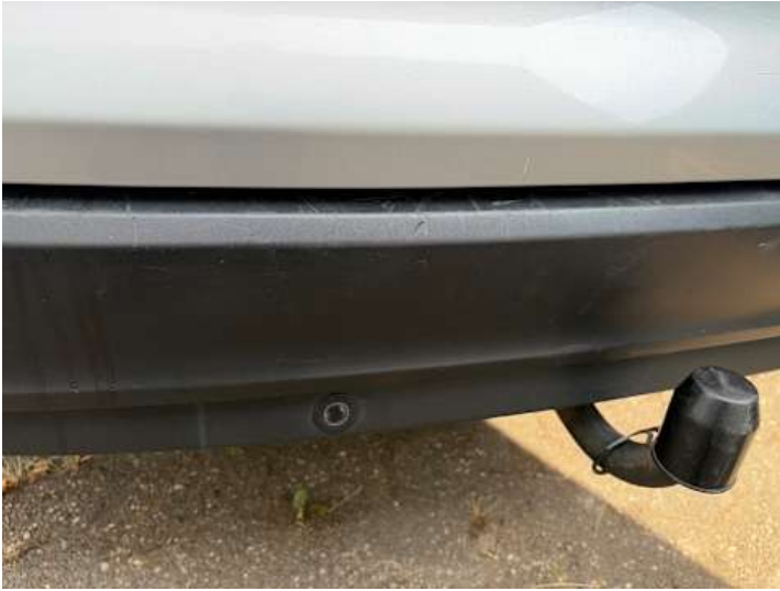
Stoßstange hinten (Lackschaden, Kratzer)
