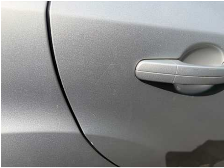
Türe hinten rechts (Lackschaden, Kratzer)
