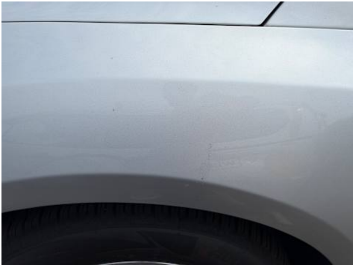
Kotflügel vorne links (Lackschaden, Kratzer)
