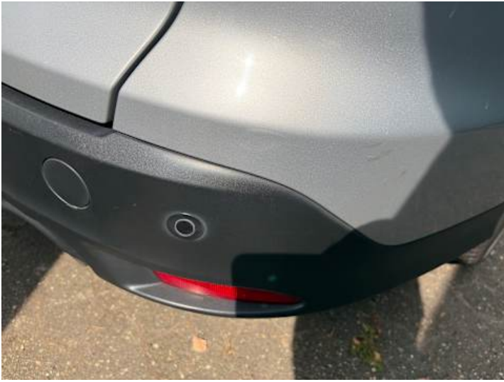
Stoßstange hinten (Lackschaden, Kratzer)
