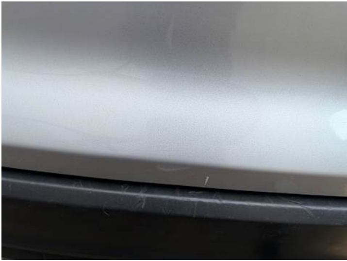
Heckklappe (Lackschaden, Kratzer)
