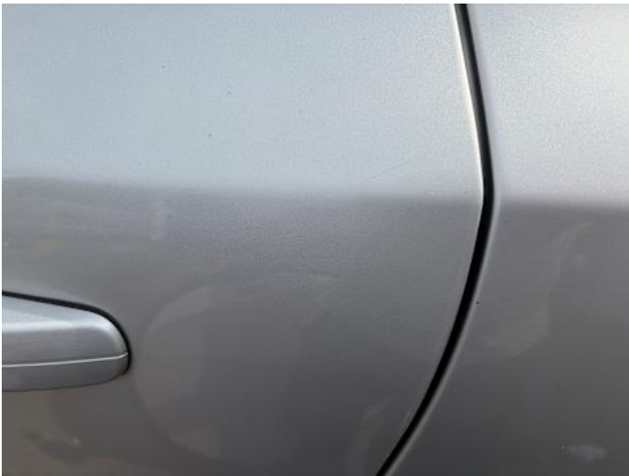
Türe hinten links (Lackschaden, Kratzer)
