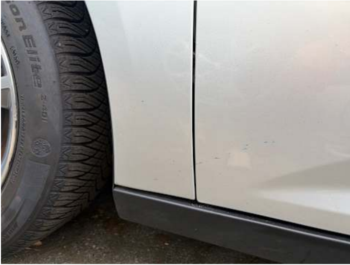
Kotflügel vorne links (Lackschaden, Kratzer)
