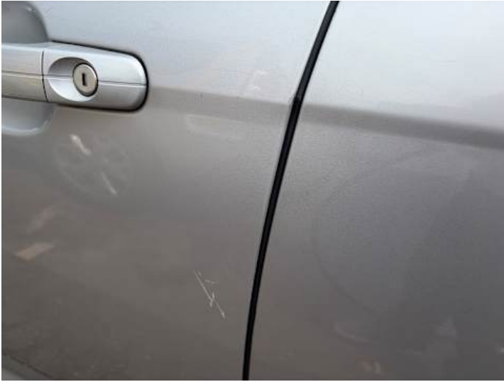
Fahrtür (Lackschaden, Kratzer)
