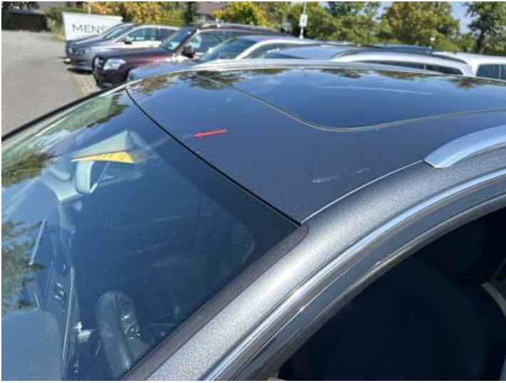
Dach (Lackschaden, Steinschlag)
