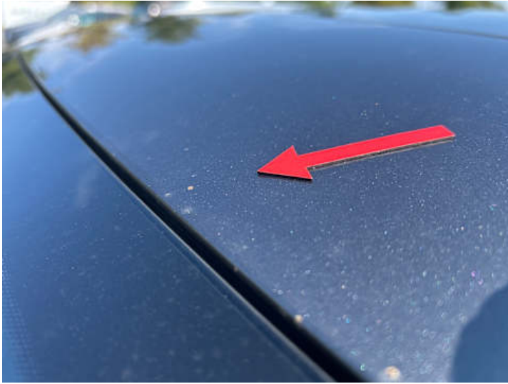
Dach (Lackschaden, Steinschlag)
