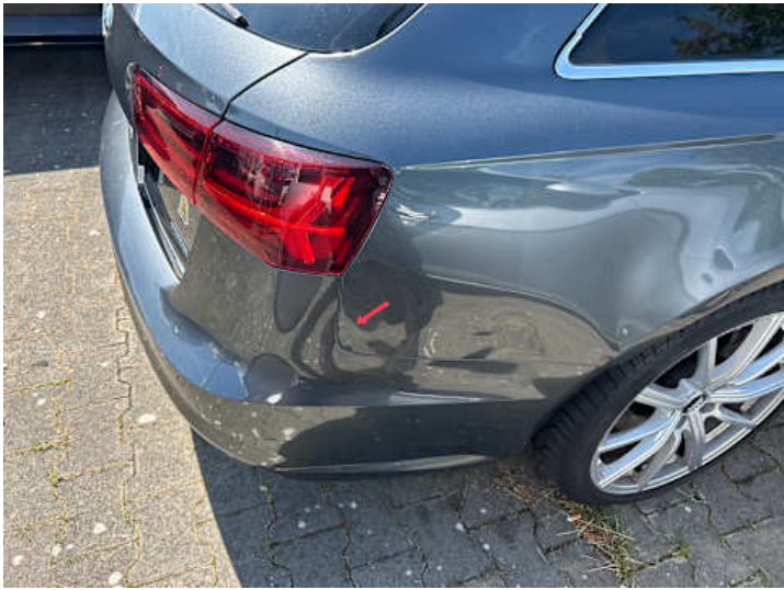
Seitenteil hinten rechts (Lackschaden, Verformung)
