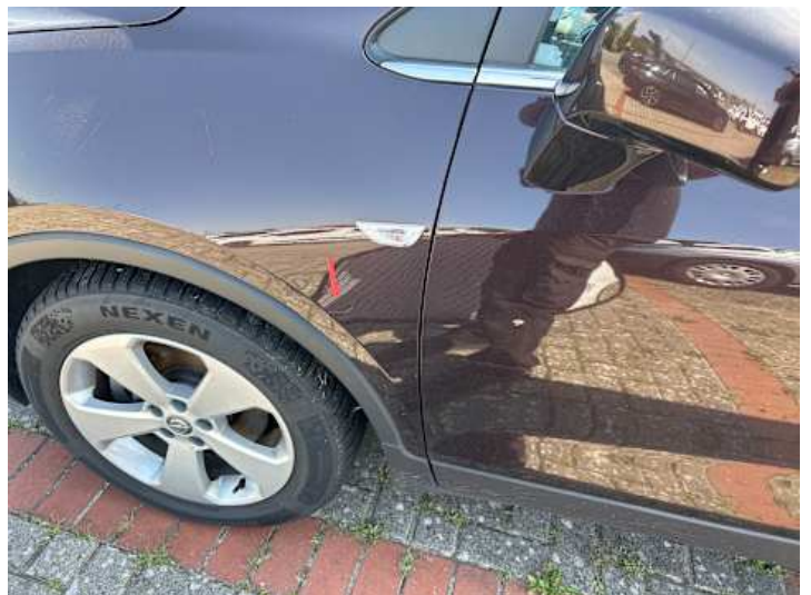
Kotflügel vorne links (Kratzer, Lackschaden)
