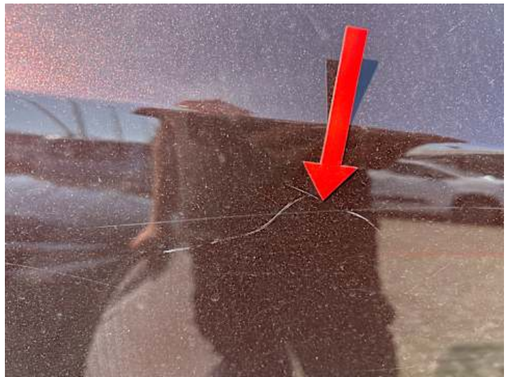
Türe hinten rechts (Lackschaden, Kratzer)
