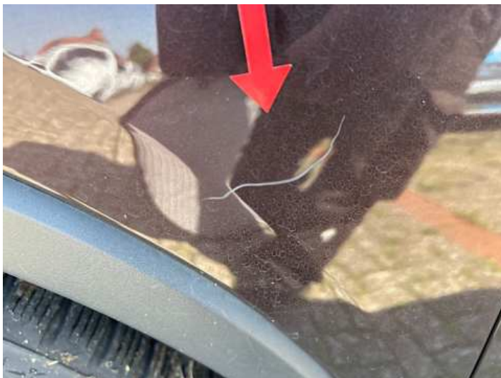
Kotflügel vorne links (Kratzer, Lackschaden)
