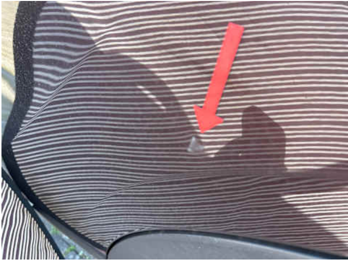
Türe hinten links (Delle, Lackschaden)
