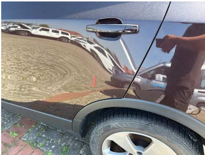
Türe hinten links (Delle, Lackschaden)
