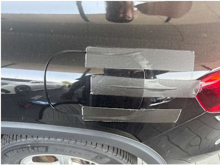
Seitenteil hinten links (Anderer Schaden): Tankklappe defekt
