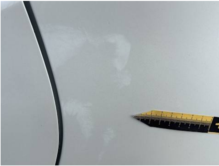
Seitenteil hinten links (Ausgeblichen/Matt, Kratzer, Unsachgemäß instand gesetzt)
