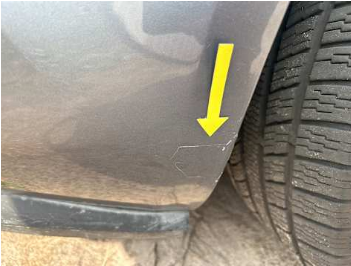
Stoßstange vorne (Lackschaden, Kratzer)
