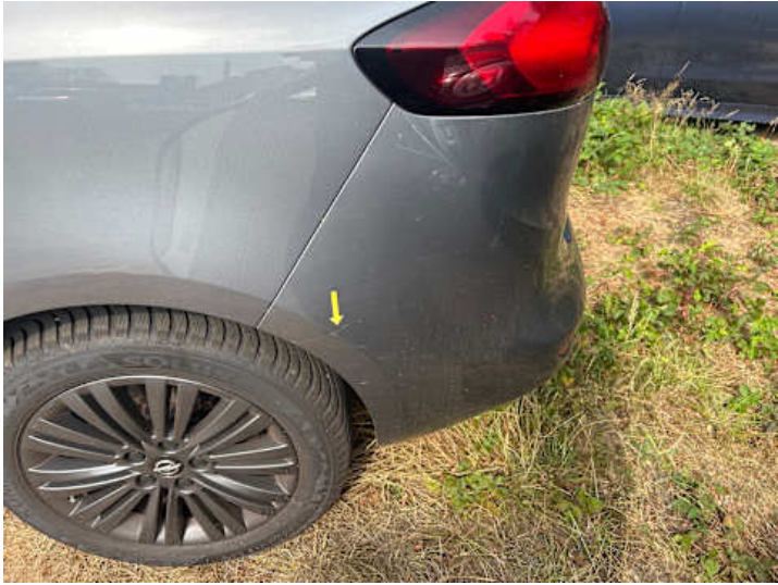
Stoßstange hinten (Lackschaden)
