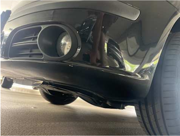
Stoßstange vorne (Kratzer, Lackschaden)
