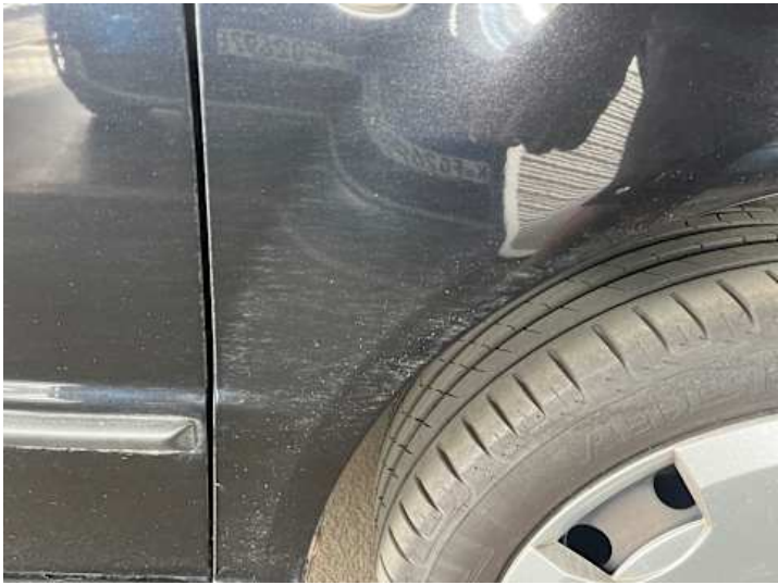
Kotflügel vorne rechts (Lackschaden, Kratzer)
