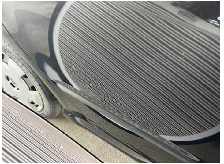
Türe hinten rechts (Delle)
