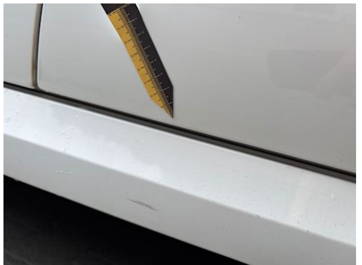
Schweller rechts (Lackschaden)
