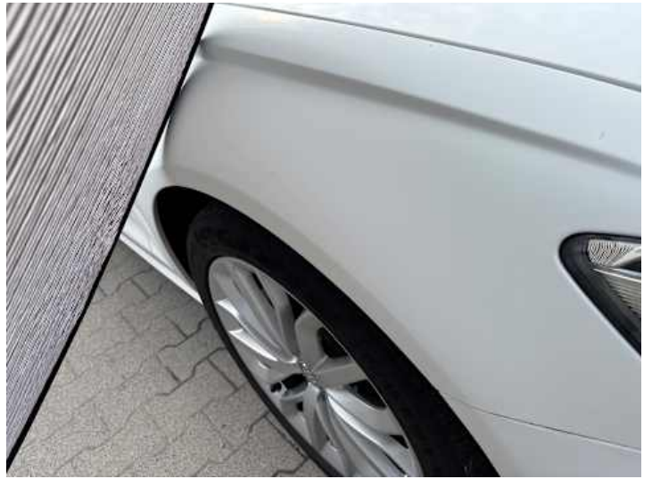
Kotflügel vorne rechts (Unsachgemäß instand gesetzt, Ausgeblichen/Matt)
