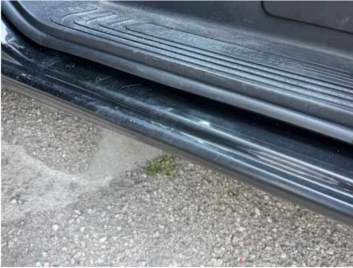
Schweller links (Kratzer)
