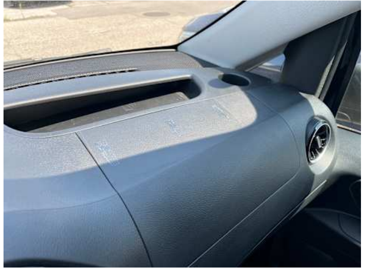
Innenraum (Anderer Schaden): Klebereste
