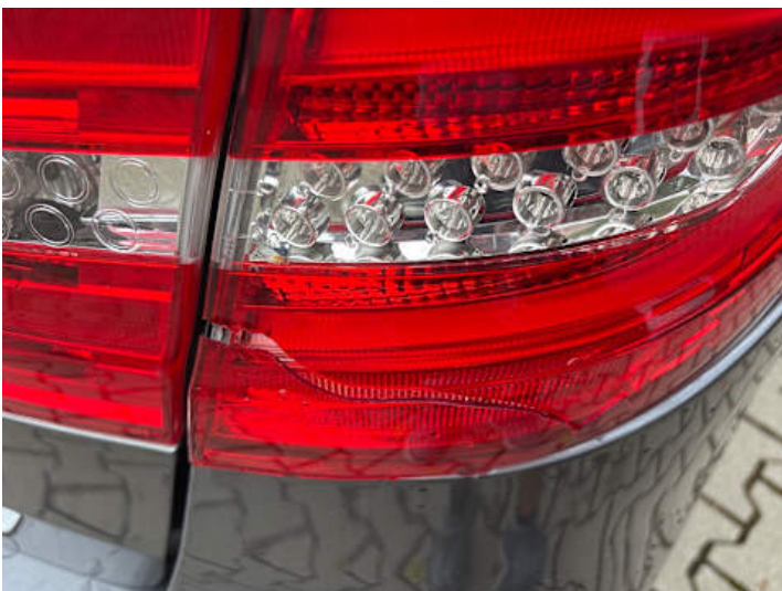
Rücklicht (rechts) (Riss/Bruch)
