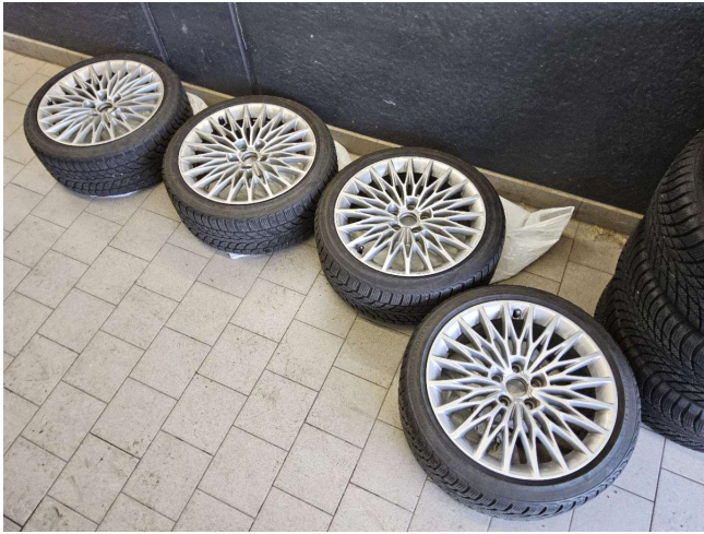
2. Radsatz 4x Radnabendeckel fehlen (DEKRA)
