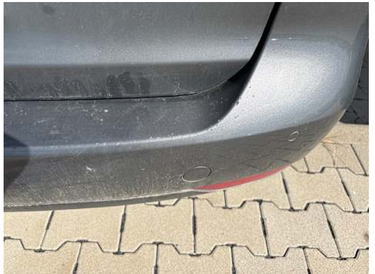
Stoßstange hinten (Kratzer)
