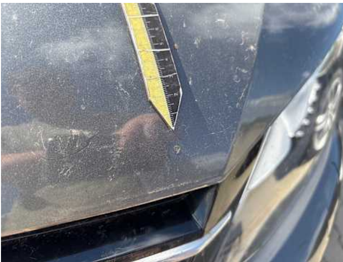
Motorhaube (Lackschaden, Rost)
