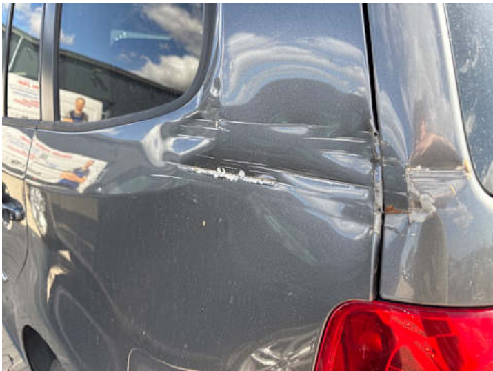
Seitenteil hinten links (Verformung, Lackschaden, Kratzer, Rost)
