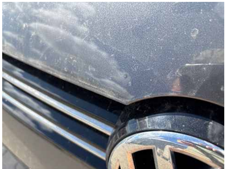
Motorhaube (Lackschaden, Rost)
