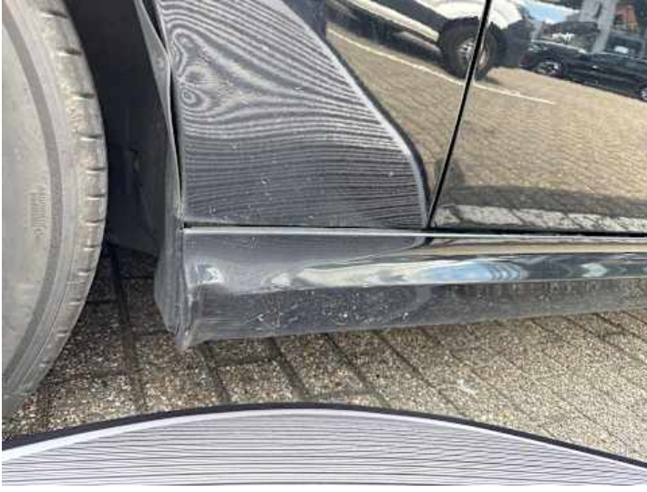
Schweller links (Lackschaden, Verformung, Spaltmaße ungenau)
