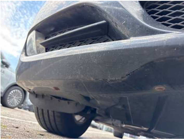
Stoßstange vorne (Kratzer, Lackschaden)
