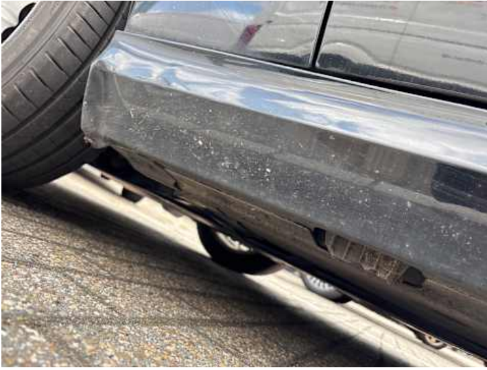
Schweller links (Lackschaden, Verformung, Spaltmaße ungenau)
