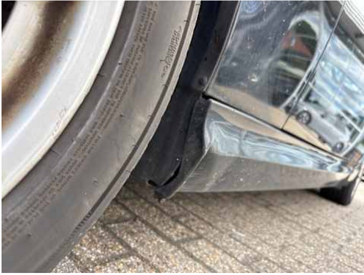
Schweller links (Lackschaden, Verformung, Spaltmaße ungenau)
