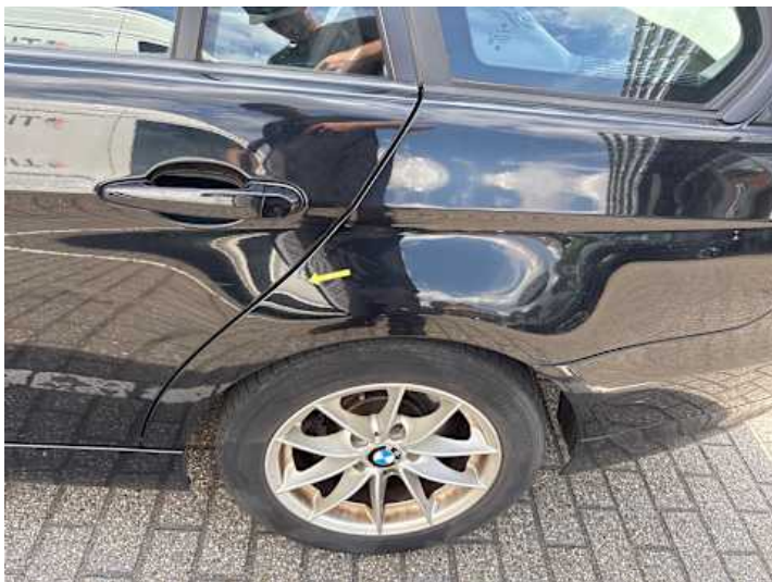
Seitenteil hinten links (Delle)
