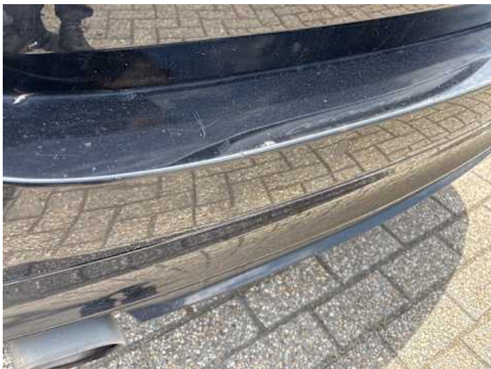
Stoßstange hinten (Kratzer, Lackschaden)
