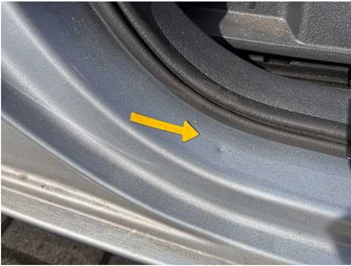
Schweller rechts (Delle)
