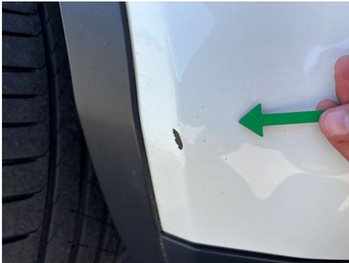
Stoßstange hinten (Kratzer)
