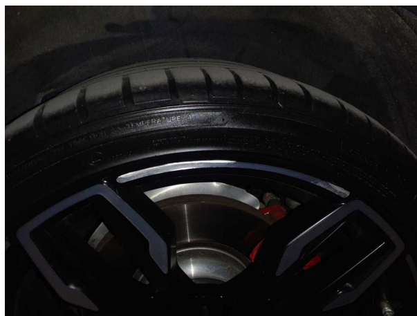
Beschädigung 3: Rad/Reifen: Leichtmetallfelge hinten rech... nicht fachgerecht instandgesetzt - Wertminderung
