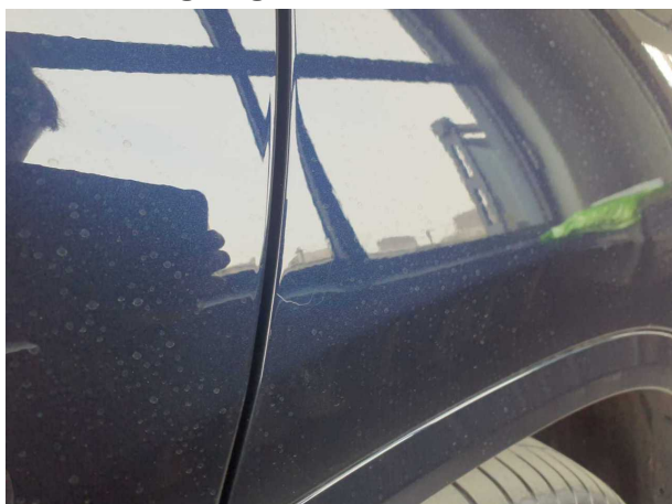
Beschädigung 1: Seitenwand links: Seitenwand - Kratzer - auslegen / polieren
