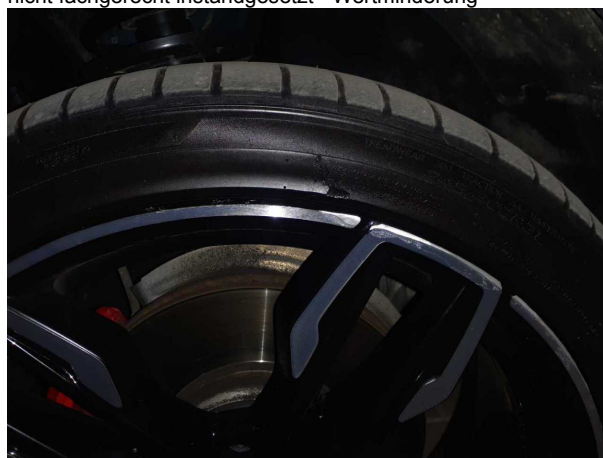
Beschädigung 5: Rad/Reifen: Leichtmetallfelge vorn rechts - nicht fachgerecht instandgesetzt - Wertminderung
