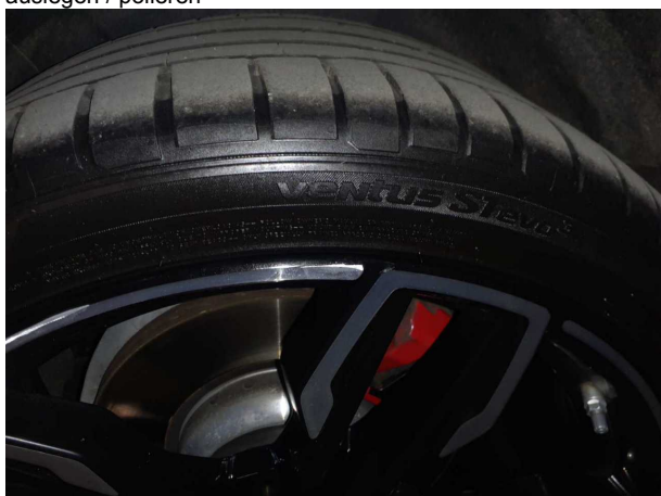
Beschädigung 3: Rad/Reifen: Leichtmetallfelge hinten rechts - nicht fachgerecht instandgesetzt - Wertminderung
