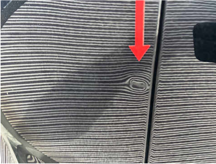
Türe hinten rechts (Verformung)
