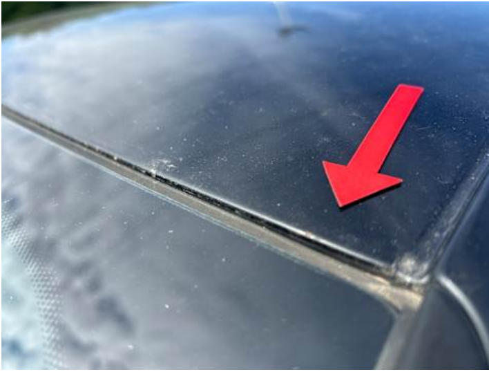
Dach (Lackschaden, Steinschlag)
