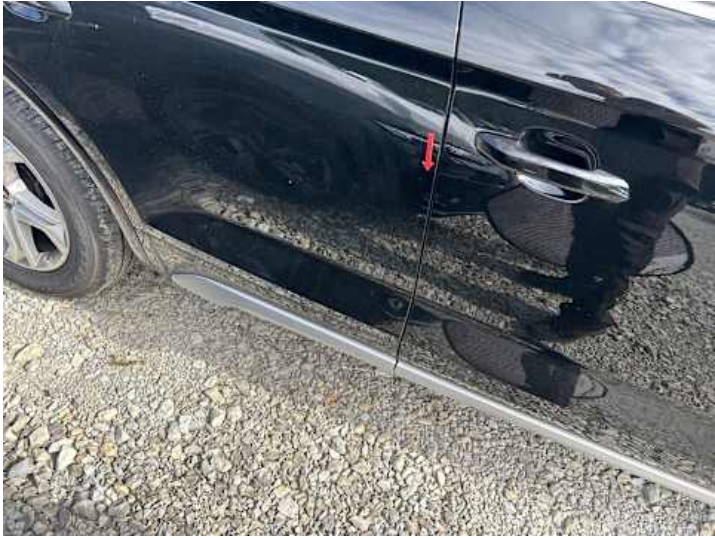
Türe hinten rechts (Verformung)
