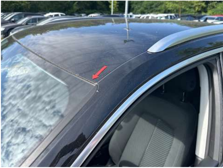
Dach (Lackschaden, Steinschlag)
