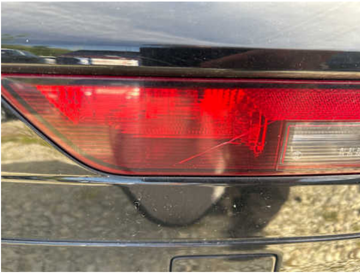
Rücklicht (rechts) (Riss/Bruch)
