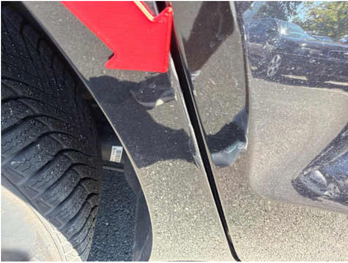
Seitenteil hinten rechts (Lackschaden, Kratzer)
