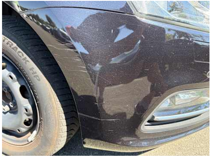
Stoßstange vorne (Kratzer, Lackschaden)
