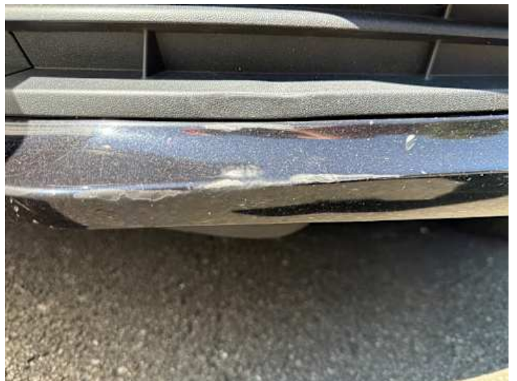
Stoßstange vorne (Kratzer, Lackschaden)
