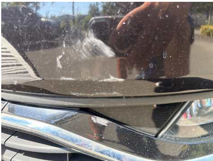
Stoßstange vorne (Kratzer, Lackschaden)
