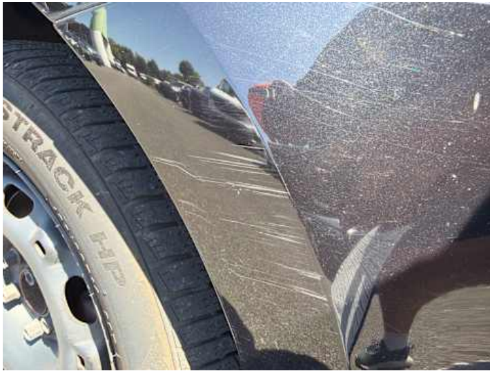
Stoßstange vorne (Kratzer, Lackschaden)
