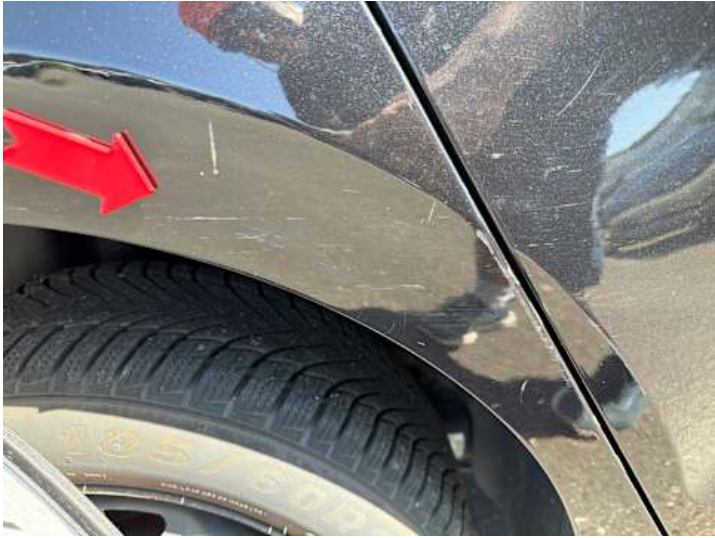
Seitenteil hinten rechts (Lackschaden, Kratzer)
