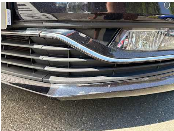
Stoßstange vorne (Kratzer, Lackschaden)
