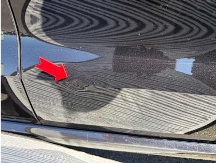
Beifahrertür (Kratzer, Delle)
