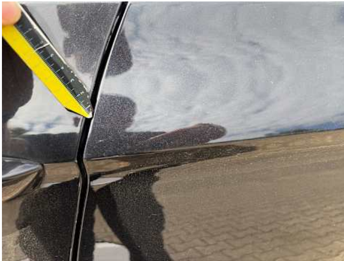
Türe hinten links (Lackschaden, Kratzer)
