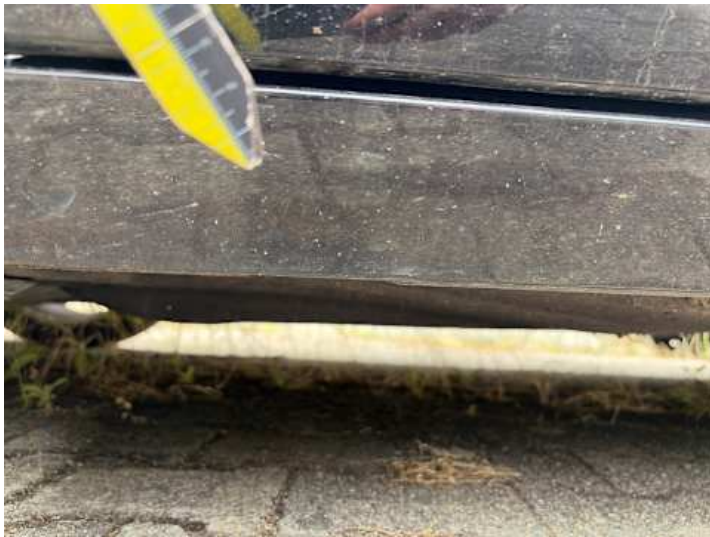
Schweller links (Lackschaden, Kratzer, Verformung)
