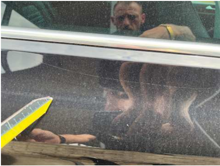
Türe hinten rechts (Lackschaden, Kratzer)
