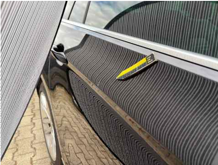
Türe hinten rechts (Delle)
