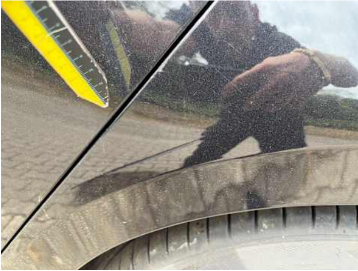
Seitenteil hinten links (Lackschaden, Kratzer)
