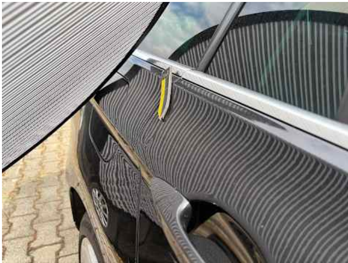
Türe hinten rechts (Delle)
