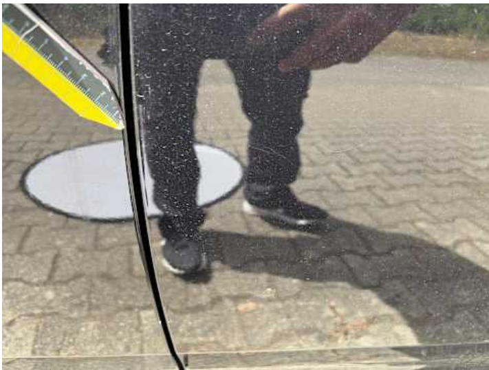
Türe hinten links (Lackschaden, Kratzer)
