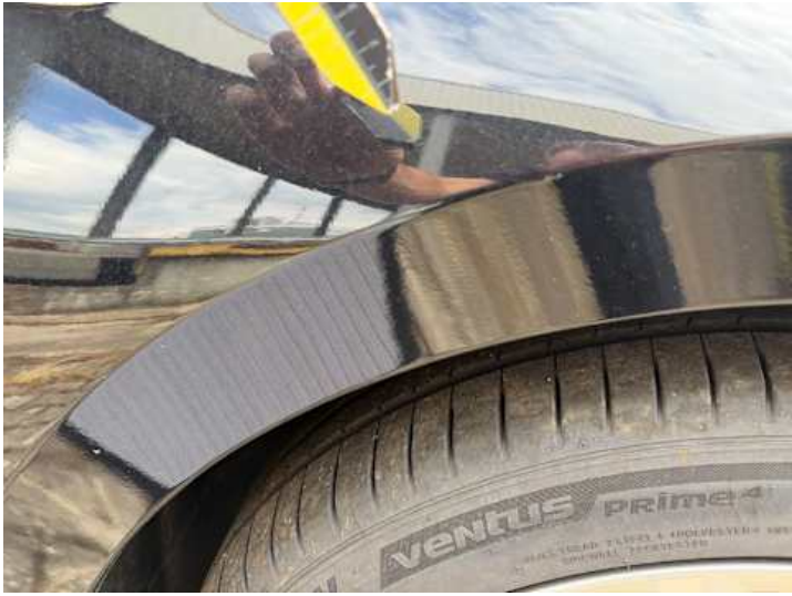
Kotflügel vorne rechts (Lackschaden, Kratzer)
