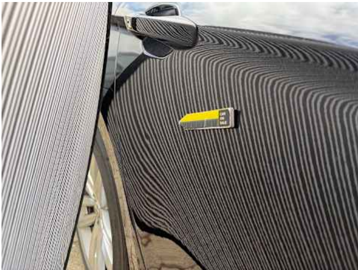
Türe hinten rechts (Delle)
