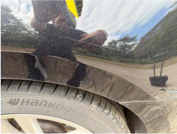
Seitenteil hinten links (Lackschaden, Kratzer)
