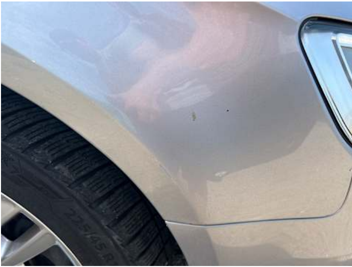
Kotflügel vorne rechts (Lackschaden, Delle)
