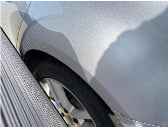
Seitenteil hinten links (Unsachgemäß instand gesetzt)
