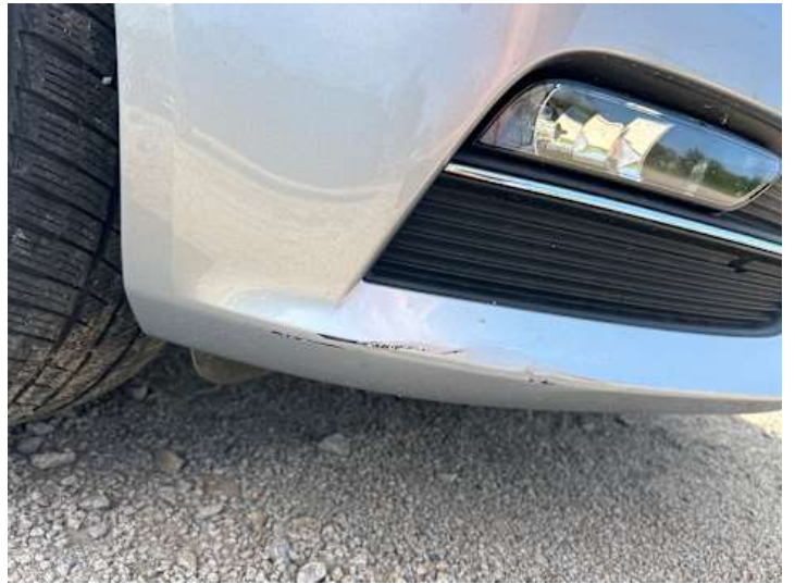
Stoßstange vorne (Kratzer, Lackschaden)
