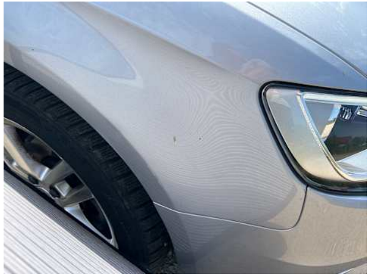
Kotflügel vorne rechts (Lackschaden, Delle)
