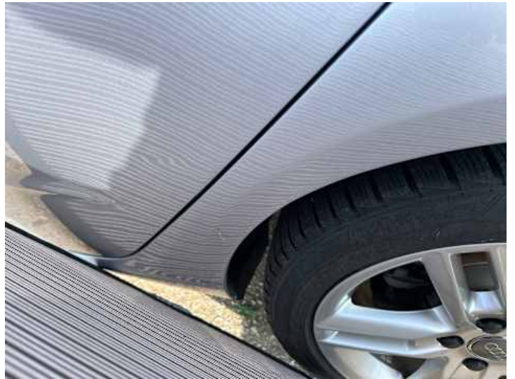
Seitenteil hinten links (Unsachgemäß instand gesetzt)
