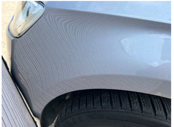
Kotflügel vorne links (Delle, Kratzer)
