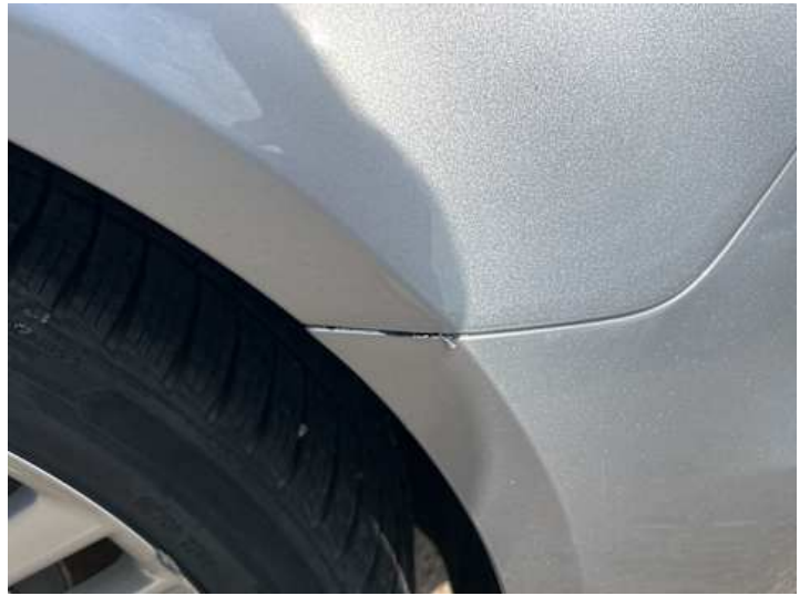
Stoßstange hinten (Kratzer, Lackschaden)
