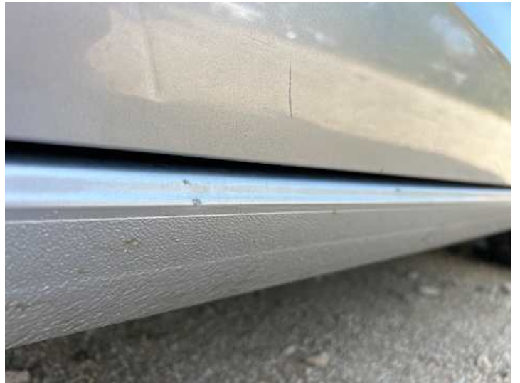
Schweller rechts (Delle, Kratzer)
