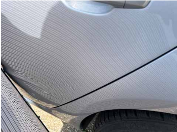
Türe hinten links (Delle, Unsachgemäß instand gesetzt)
