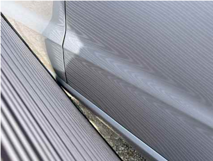
Türe hinten links (Delle, Unsachgemäß instand gesetzt)
