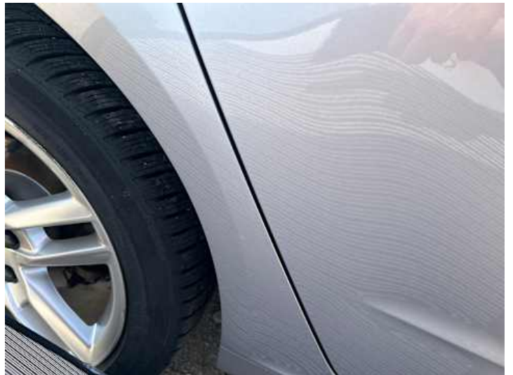
Seitenteil hinten rechts (Delle, Kratzer)
