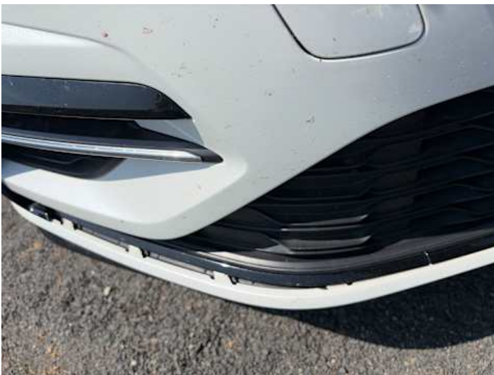
Stoßstange vorne (Riss/Bruch)
