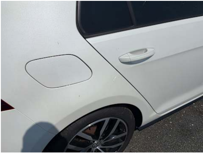
Seitenteil hinten rechts (Lackschaden)
