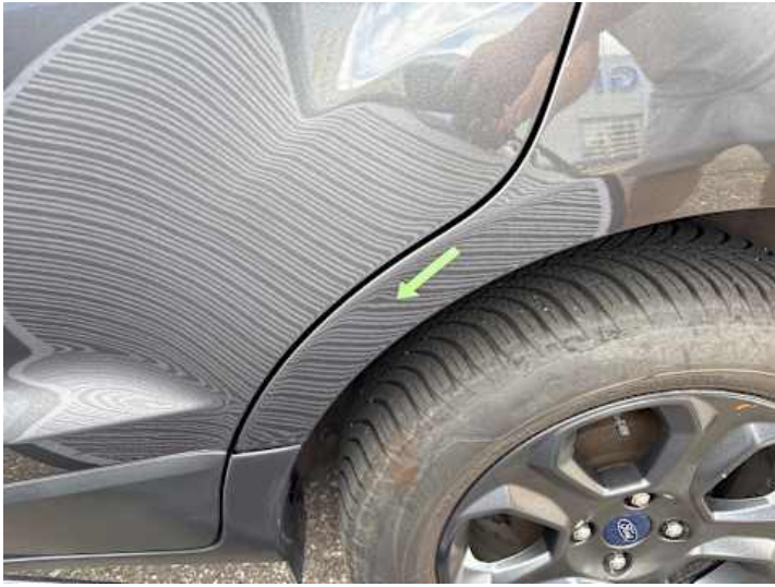
Seitenteil hinten links (Delle)
