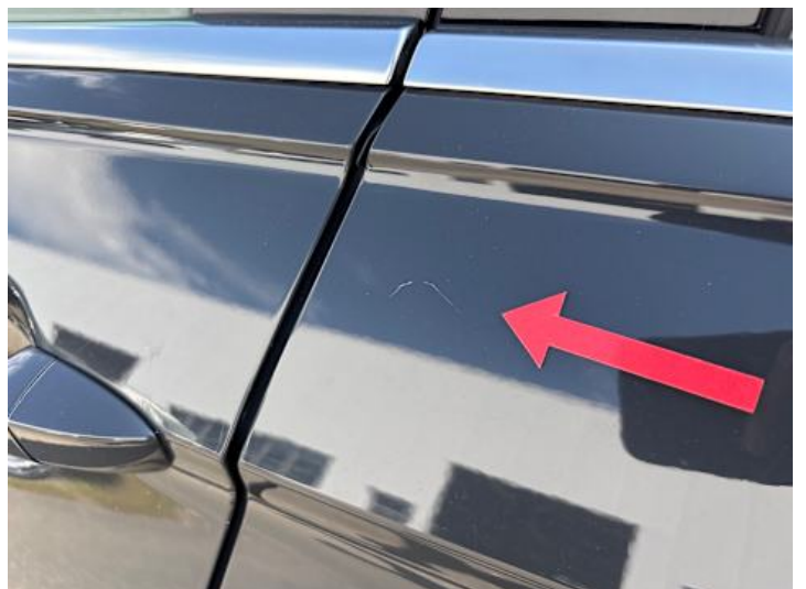
Türe hinten links (Kratzer)
