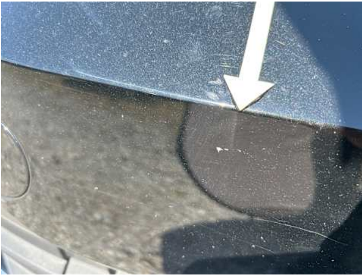
Stoßstange vorne (Lackschaden, Steinschlag)
