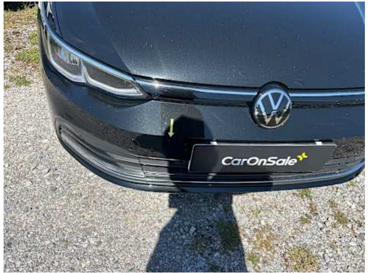
Stoßstange vorne (Lackschaden, Steinschlag)
