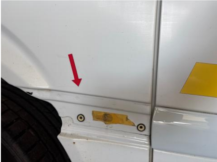
Seitenteil hinten rechts (Riss/Bruch)
