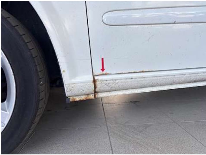
Fahrtür (Lackschaden, Rost)
