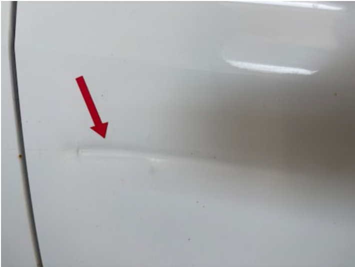
Türe hinten rechts (Verformung, Lackschaden)
