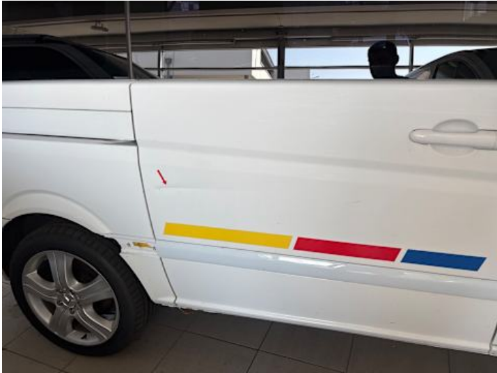
Türe hinten rechts (Verformung, Lackschaden)
