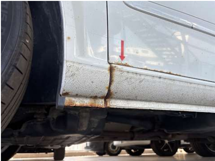
Schweller links (Rost)
