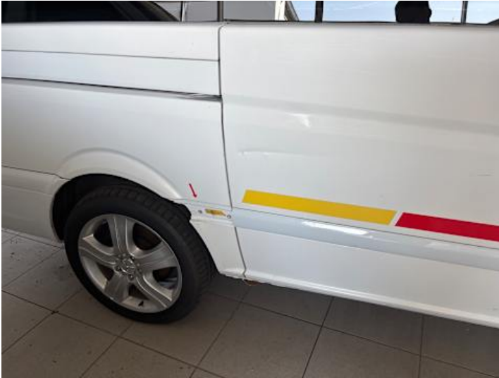
Seitenteil hinten rechts (Riss/Bruch)
