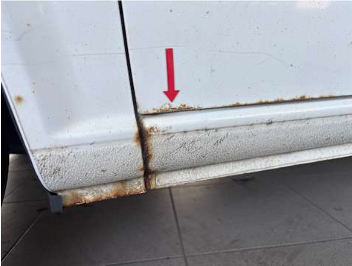
Fahrtür (Lackschaden, Rost)
