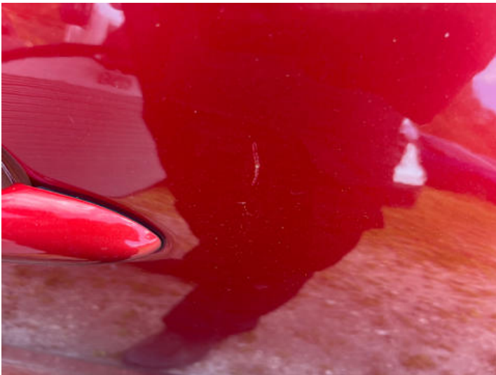
Beifahrtür (Kratzer, Lackschaden)
