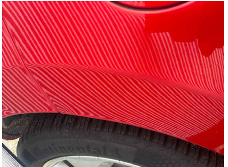
Seitenteil hinten rechts (Verformung)
