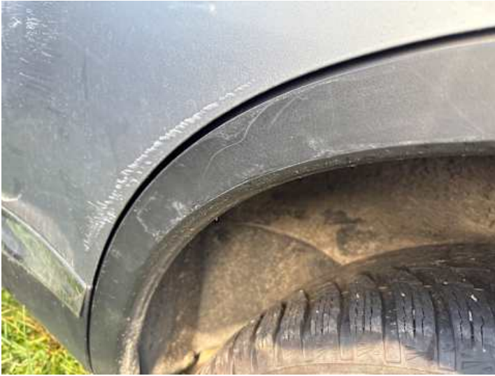
Seitenteil hinten links (Kratzer, Verformung)
