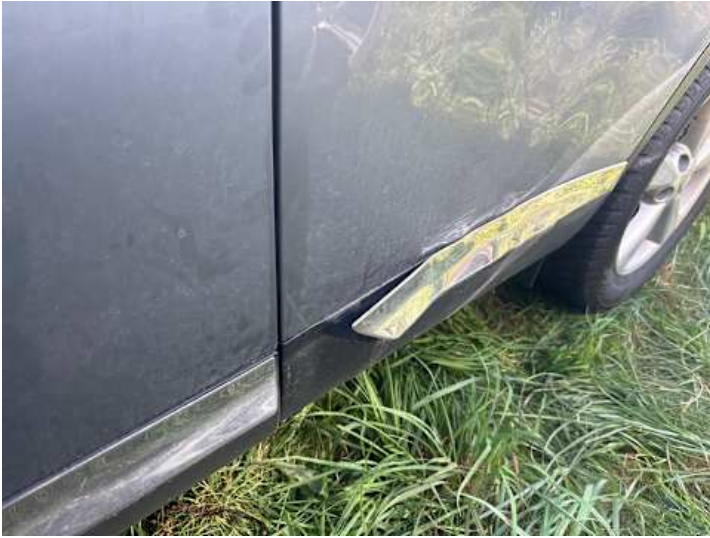
Türe hinten links (Lackschaden, Verformung, Kratzer)
