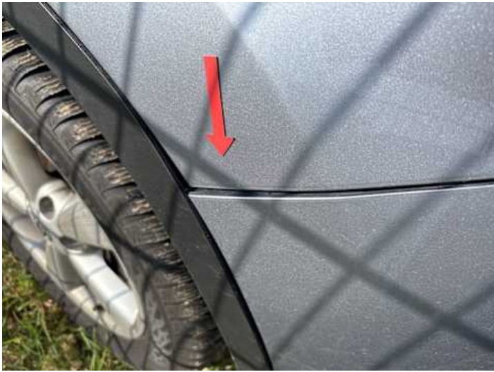
Kotflügel vorne rechts (Spaltmaße ungenau)
