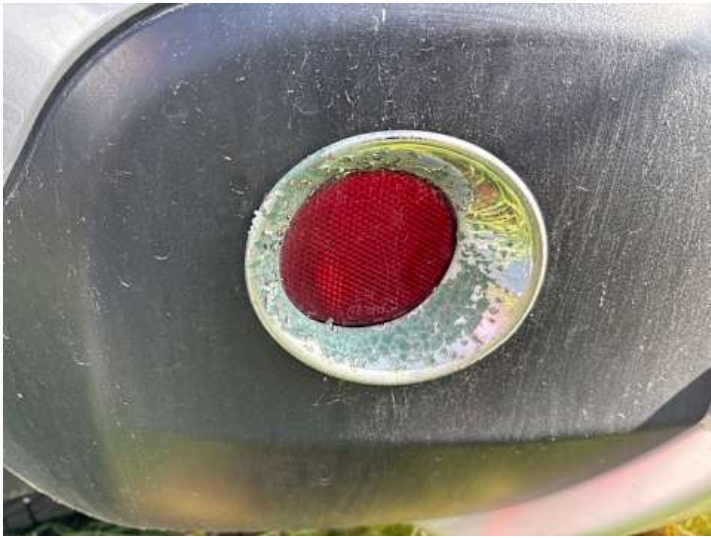
Rücklicht (links) (Anderer Schaden): Beschichtung löst sich
