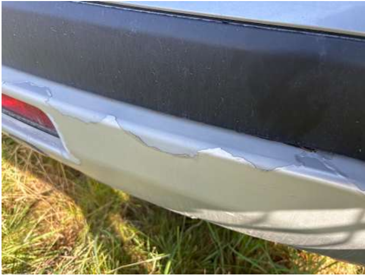
Stoßstange hinten (Anderer Schaden): Beschichtung löst sich
