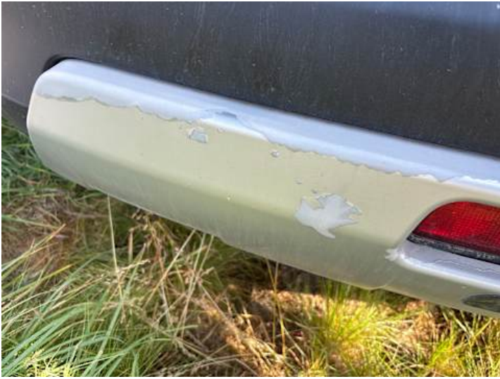
Stoßstange hinten (Anderer Schaden): Beschichtung löst sich
