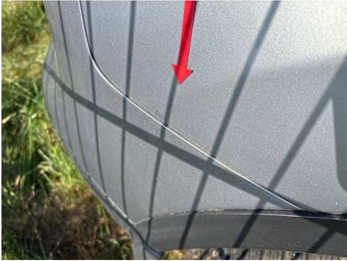
Seitenteil hinten rechts (Spaltmaße ungenau)
