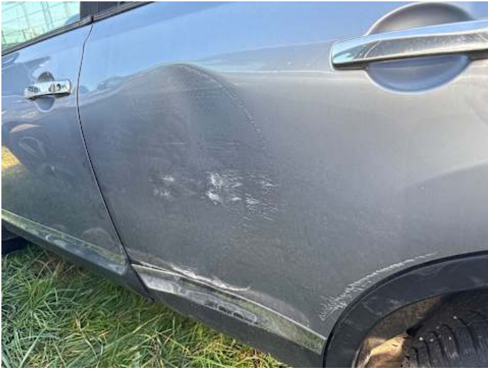
Türe hinten links (Lackschaden, Verformung, Kratzer)
