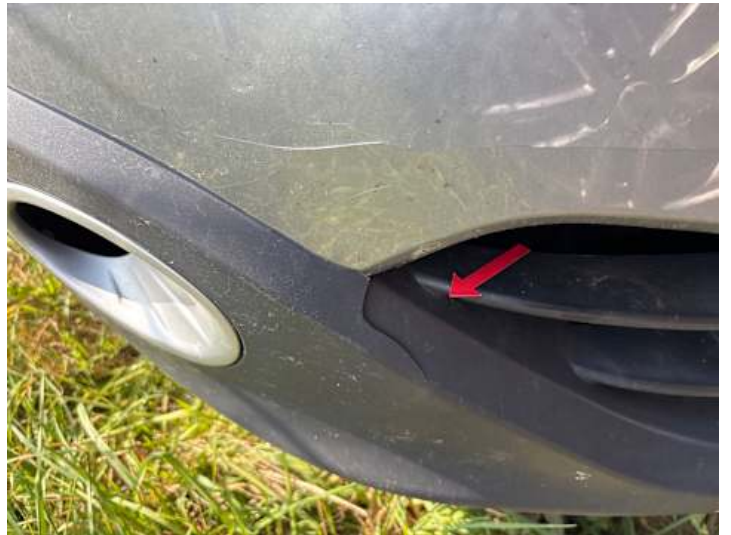
Stoßstange vorne (Riss/Bruch, Kratzer)
