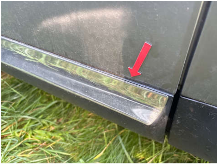
Fahrertür (Anderer Schaden): Schutzleiste lose
