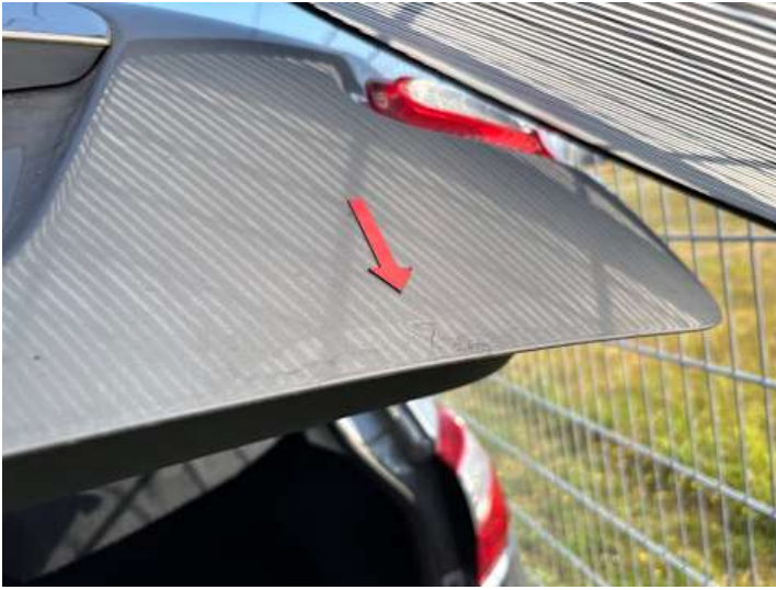
Heckklappe (Delle, Lackschaden)
