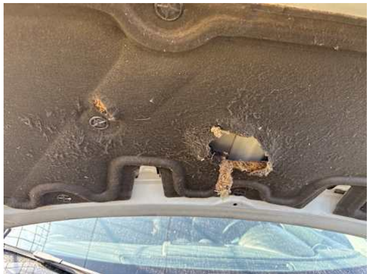
Motorhaube (Anderer Schaden): Dämmmatte beschädigt
