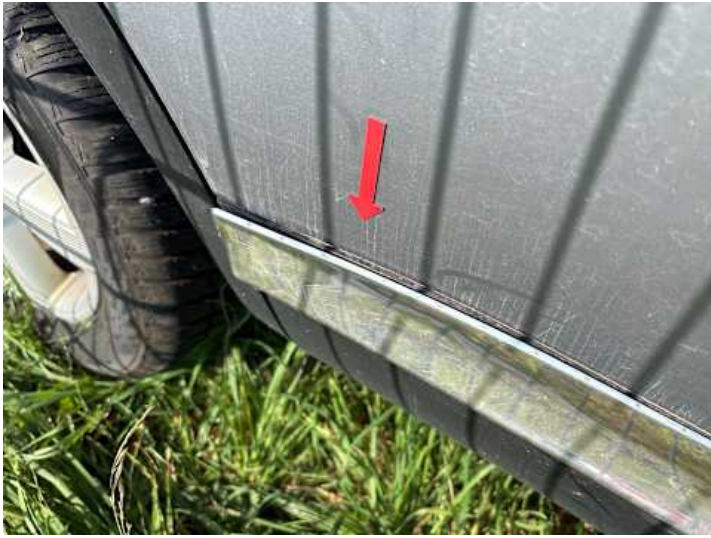
Türe hinten rechts (Anderer Schaden): Schutzleiste lose
