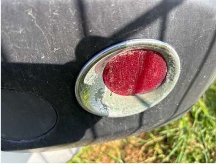
Rücklicht (rechts) (Anderer Schaden): Beschichtung löst sich
