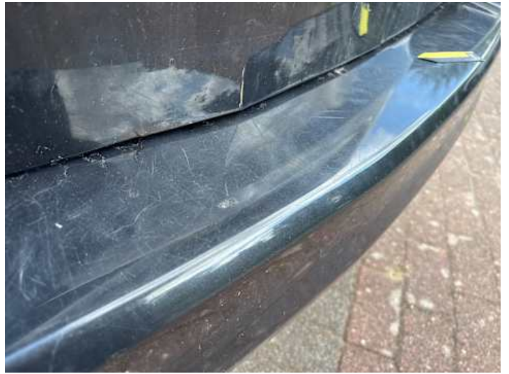
Stoßstange hinten (Kratzer, Lackschaden)
