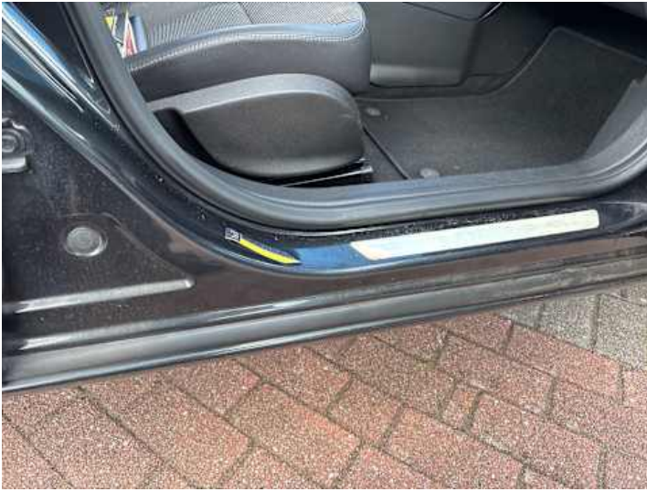
Schweller rechts (Kratzer)
