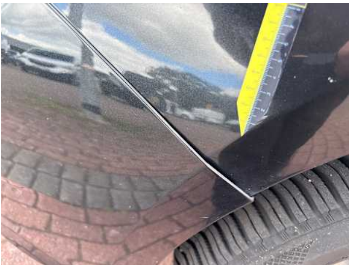
Stoßstange vorne (Spaltmaße ungenau)
