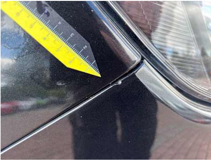
Stoßstange vorne (Lackschaden)
