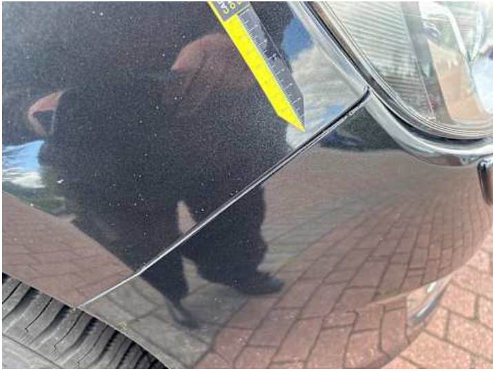
Kotflügel vorne rechts (Spaltmaße ungenau)
