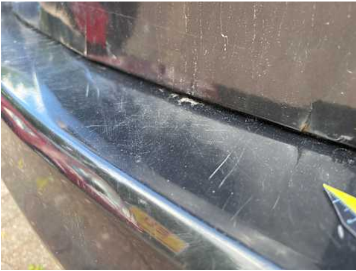
Stoßstange hinten (Kratzer, Lackschaden)
