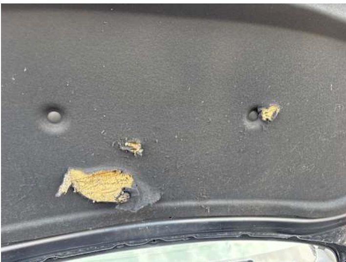
Motorhaube (Anderer Schaden): Motordämmung beschädigt
