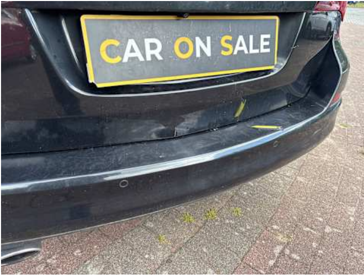
Heckklappe (Lackschaden, Riss/Bruch, Unsachgemäß instand gesetzt)
