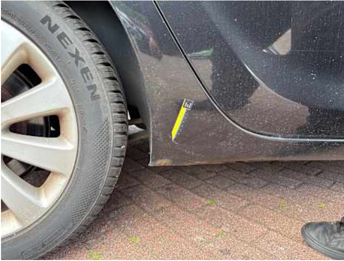
Schweller rechts (Lackschaden, Rost)
