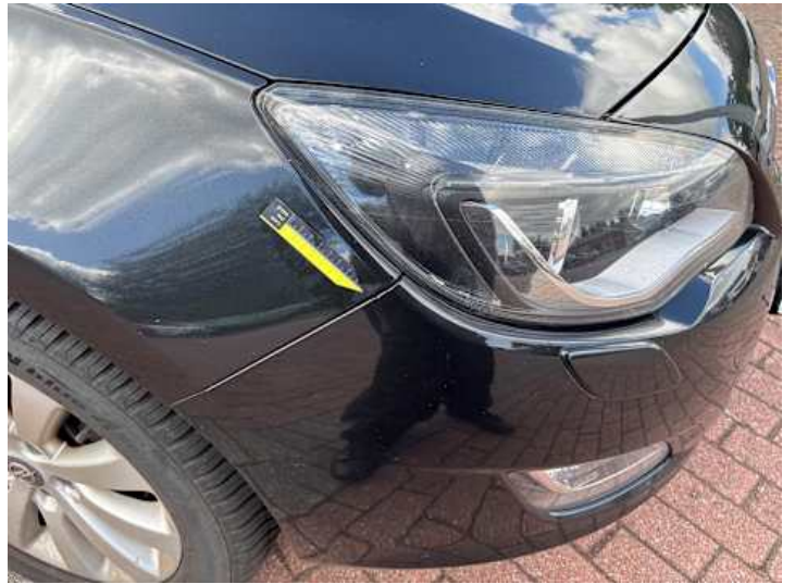
Stoßstange vorne (Lackschaden)
