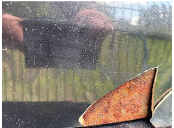
Heckklappe (Rost, Lackschaden)
