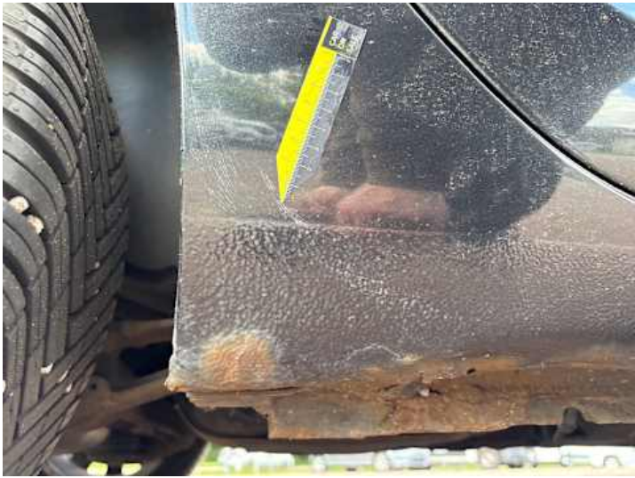
Schweller rechts (Lackschaden, Rost)
