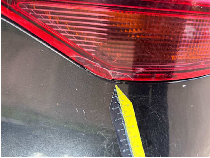
Rücklicht (rechts) (Riss/Bruch)
