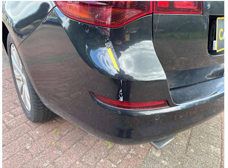
Stoßstange hinten (Verformung, Lackschaden)
