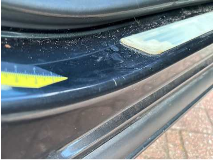
Schweller rechts (Kratzer)
