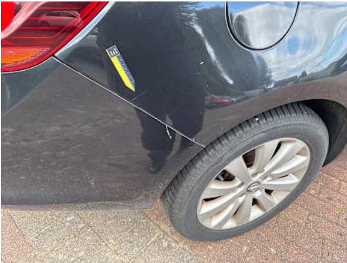
Seitenteil hinten rechts (Kratzer)
