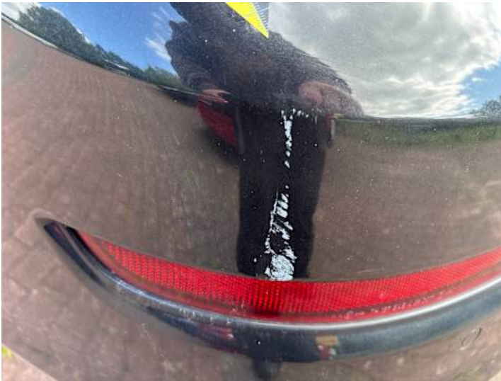
Stoßstange hinten (Verformung, Lackschaden)
