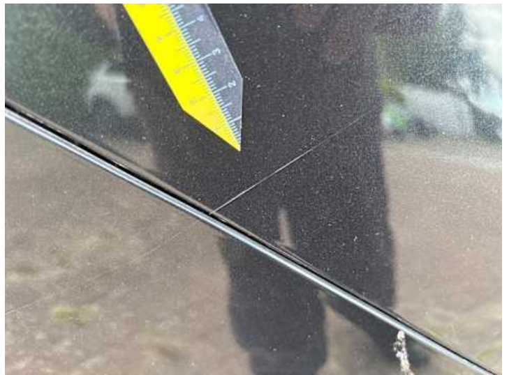
Seitenteil hinten rechts (Kratzer)
