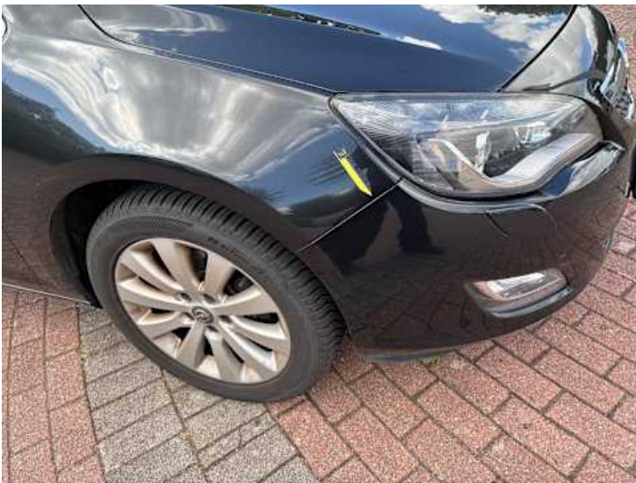
Kotflügel vorne rechts (Spaltmaße ungenau)
