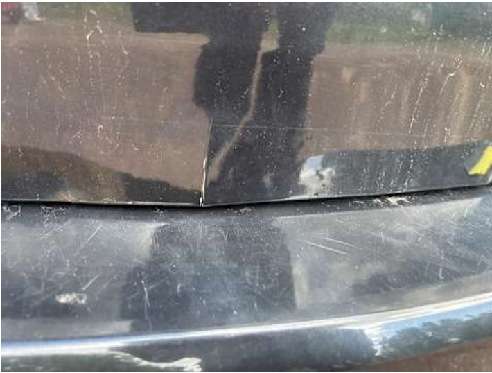
Heckklappe (Lackschaden, Riss/Bruch, Unsachgemäß instand gesetzt)
