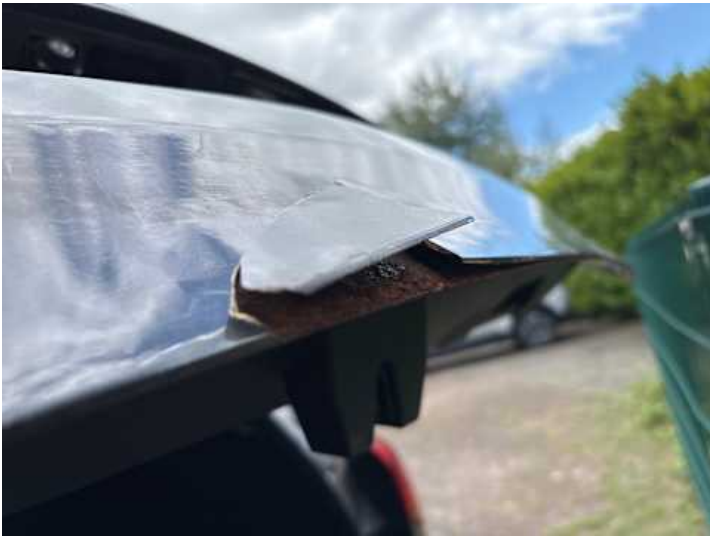
Heckklappe (Lackschaden, Riss/Bruch, Unsachgemäß instand gesetzt)
