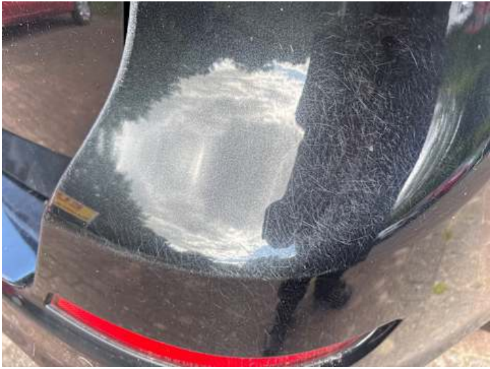
Stoßstange hinten (Kratzer, Lackschaden)
