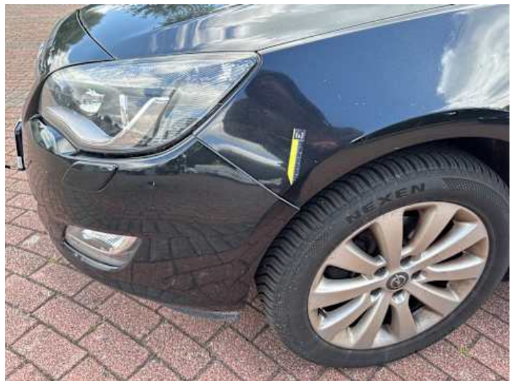
Stoßstange vorne (Spaltmaße ungenau)
