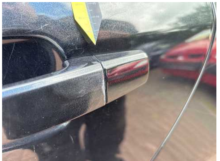
Türe hinten links (Lackschaden)
