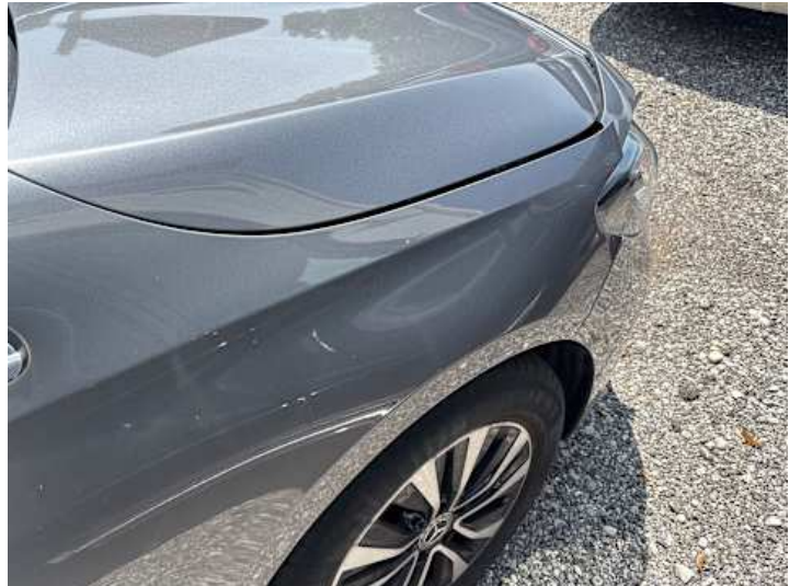
Kotflügel vorne rechts (Riss/Bruch, Spaltmaße ungenau, Kratzer, Lackschaden, Delle, Verformung)
