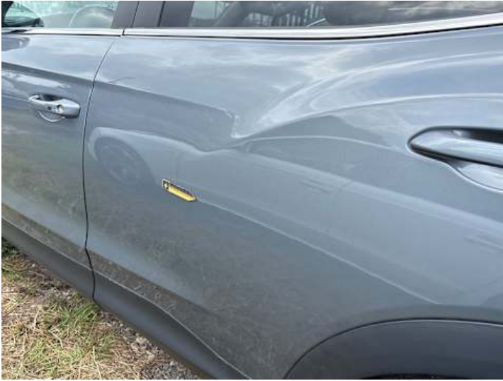
Türe hinten links (Unsachgemäß instand gesetzt)
