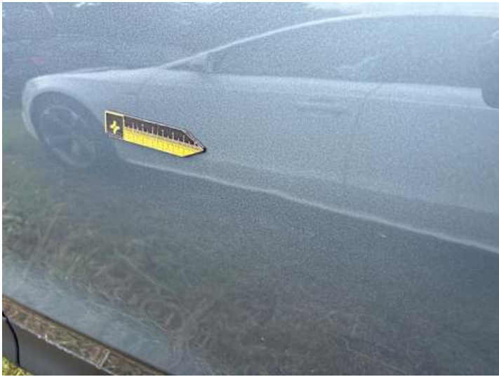
Türe hinten links (Unsachgemäß instand gesetzt)
