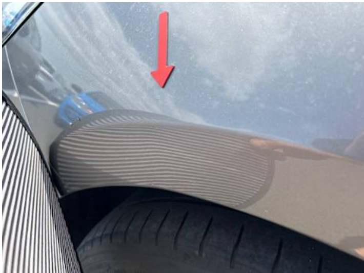
Kotflügel vorne links (Verformung)
