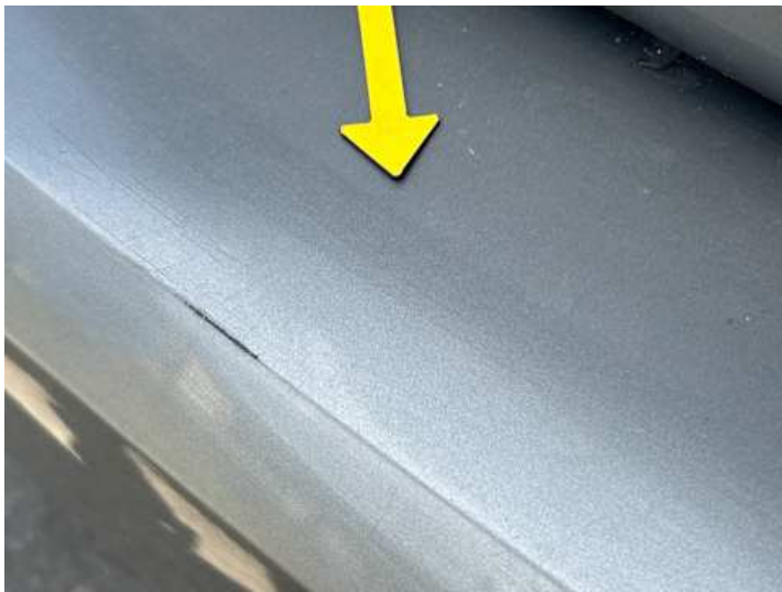
Stoßstange hinten (Kratzer, Verformung)
