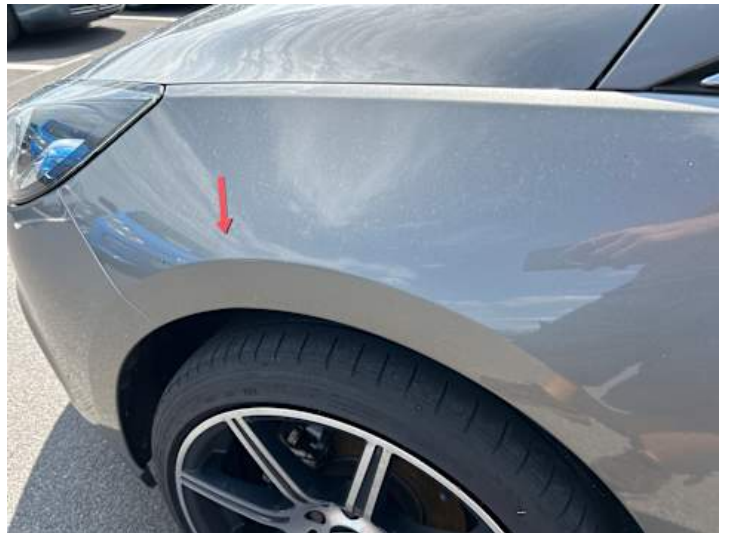
Kotflügel vorne links (Verformung)
