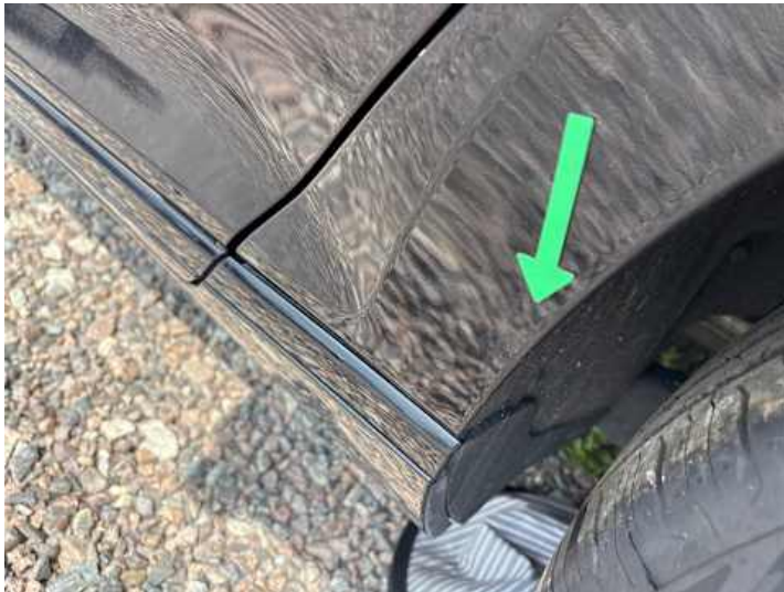
Seitenteil hinten links (Rost)
