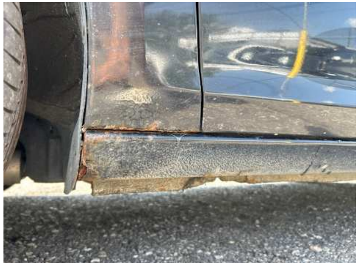
Schweller links (Rost)
