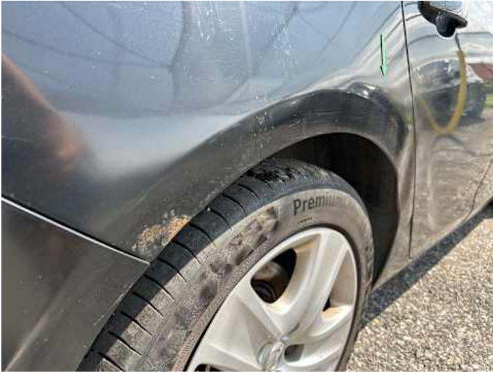
Seitenteil hinten rechts (Verformung, Lackschaden, Rost)
