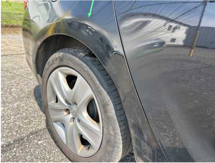
Seitenteil hinten rechts (Verformung, Lackschaden, Rost)
