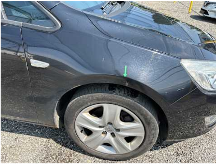
Kotflügel vorne rechts (Rost, Lackschaden)
