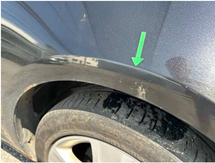
Kotflügel vorne rechts (Rost, Lackschaden)
