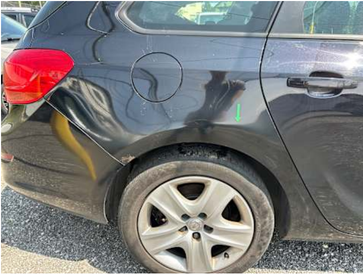
Seitenteil hinten rechts (Verformung, Lackschaden, Rost)
