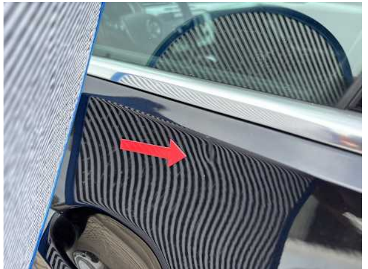
Fahrtür (Kratzer, Delle)
