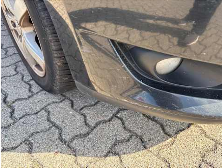
Stoßstange vorne (Spaltmaße ungenau, Riss/Bruch, Kratzer)
