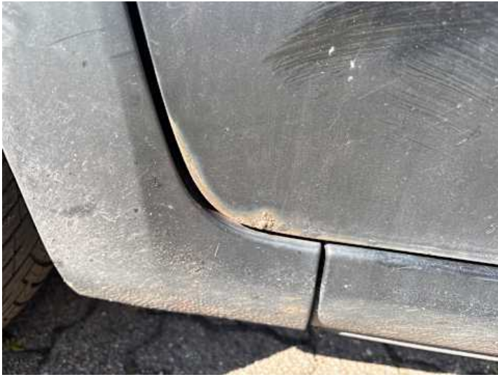
Fahrtür (Kratzer, Rost)
