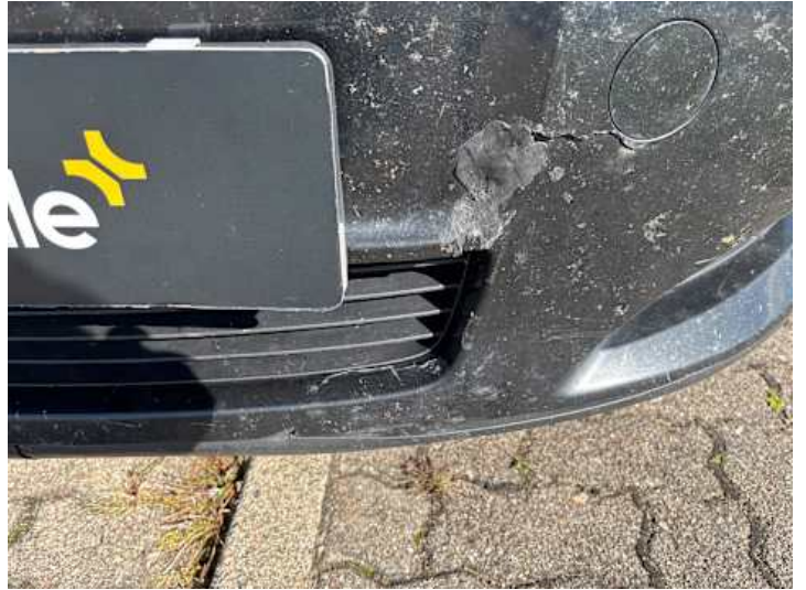
Stoßstange vorne (Spaltmaße ungenau, Riss/Bruch, Kratzer)
