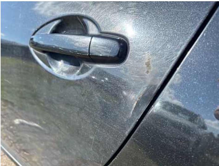
Türe hinten links (Lackschaden, Verformung, Kratzer)
