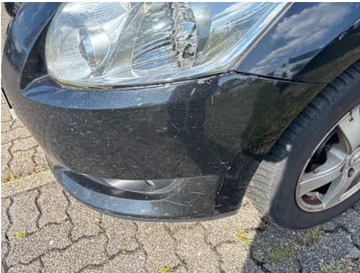
Stoßstange vorne (Spaltmaße ungenau, Riss/Bruch, Kratzer)
