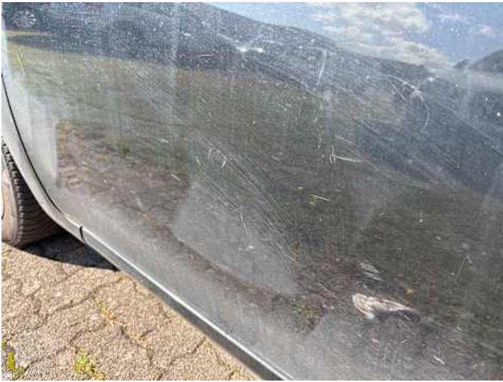
Fahrrertür (Kratzer, Rost)
