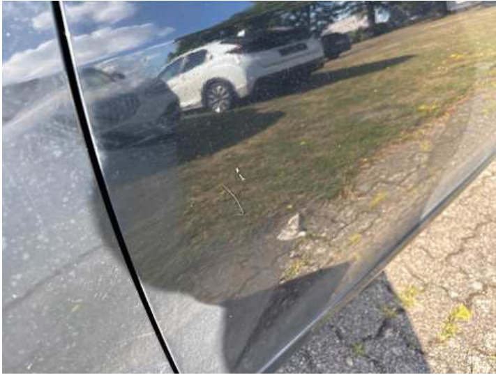
Fahrtür (Kratzer, Rost)
