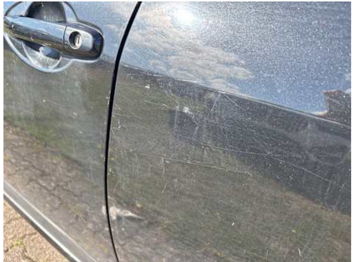
Türe hinten links (Lackschaden, Verformung, Kratzer)
