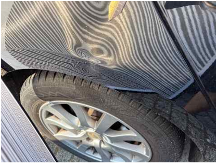
Seitenteil hinten rechts (Verformung, Lackschaden)
