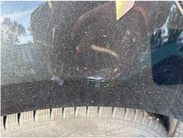
Seitenteil hinten rechts (Verformung, Lackschaden)
