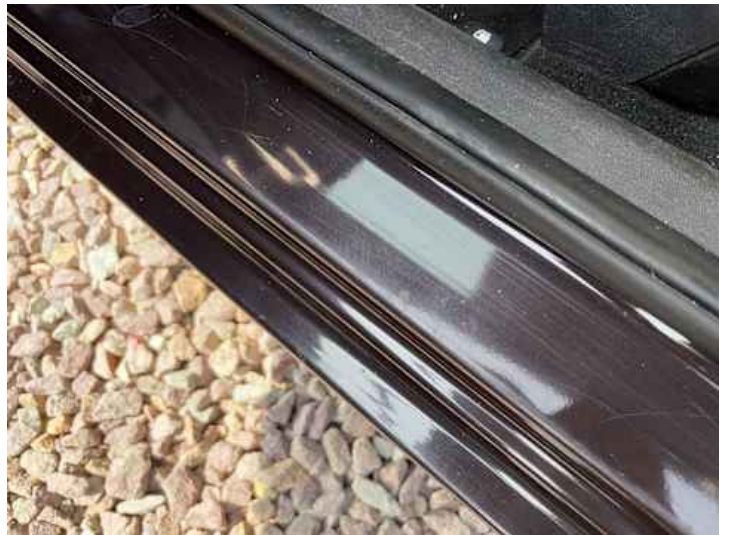
Schweller links (Kratzer)
