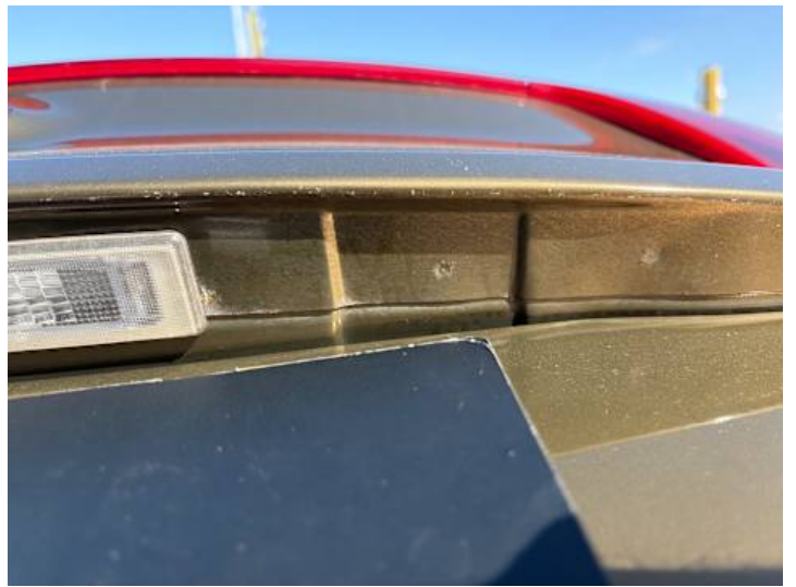
Heckklappe (Rost, Lackschaden)
