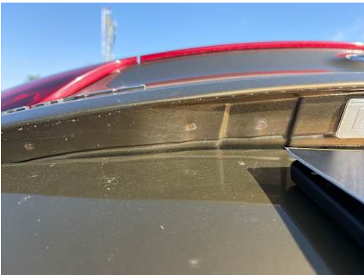
Heckklappe (Rost, Lackschaden)
