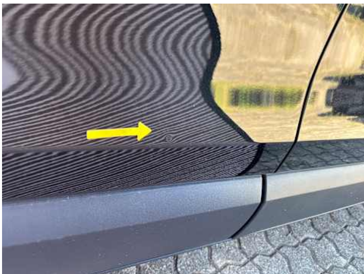
Türe hinten rechts (Delle)
