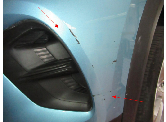
Bild 2: Außen, Stoßfänger vorne - Lackierung vorn links, verschrammt, lackieren mit Lackaufbau
