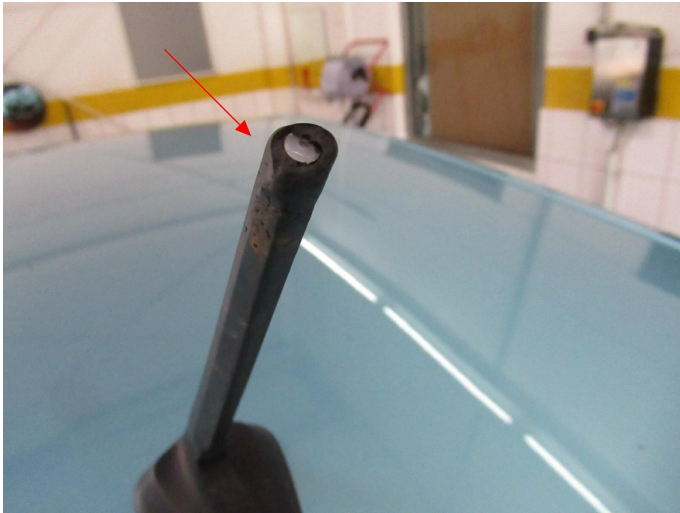
Bild 1: Außen, Dach - Antennenstab, Tierverschiss, erneuern
