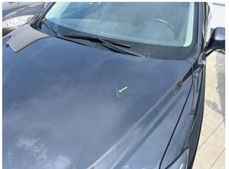
Motorhaube (Lackschaden, Kratzer, Delle)
