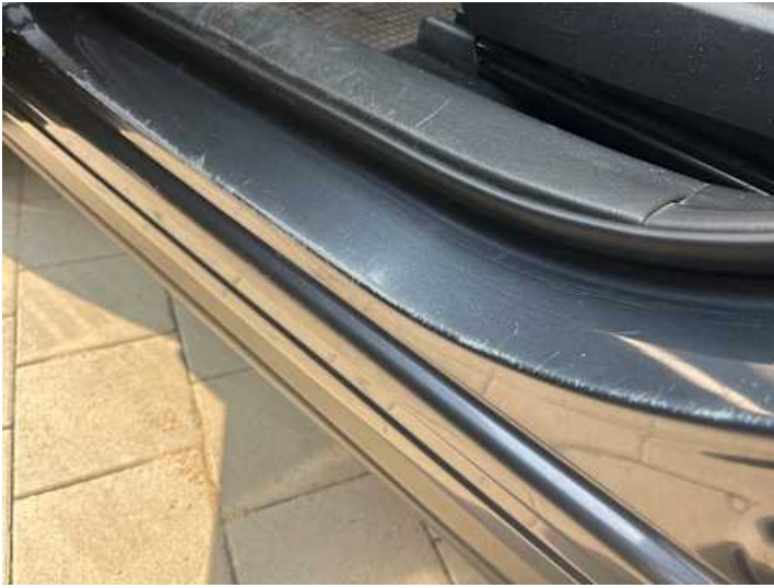
Schweller links (Lackschaden, Kratzer)
